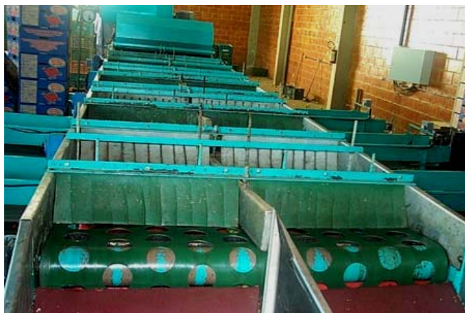
FIGURA 04. Equipamento de beneficiamento com sistema mecânico de classificação – etapa de classificação.
