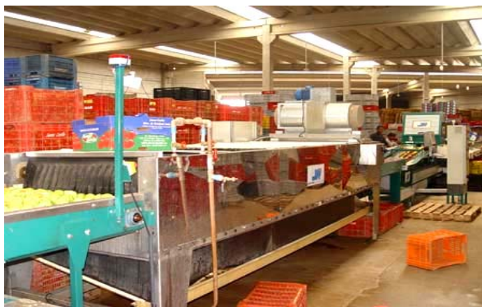
FIGURA 01. Equipamento de beneficiamento com sistema eletrônico de classificação – etapas de lavagem, secagem e polimento.
