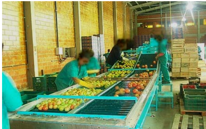
FIGURA 03. Equipamento de beneficiamento com sistema mecânico de classificação – etapa de recebimento
