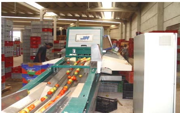
FIGURA 02. Equipamento de beneficiamento com sistema eletrônico de classificação – etapa de classificação
