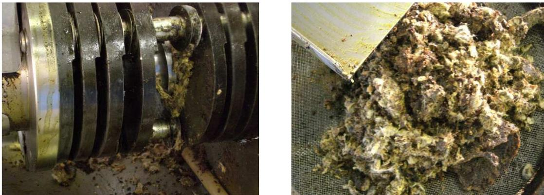
Figura 5.10 – Prensagem de caroço de algodão com alta umidade.
