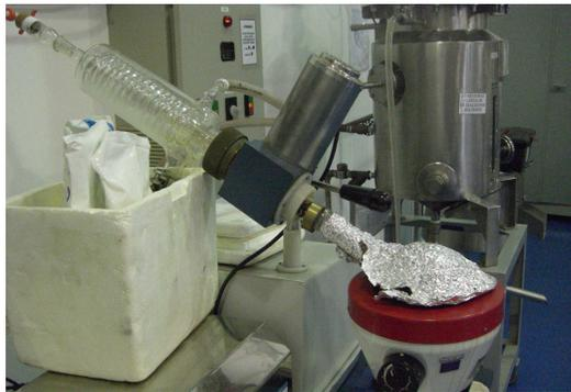
Figura 4.8 – Sistema de destilação.
