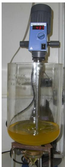
Figura 4.6 - Sistema para lavagem com água acidificada.
