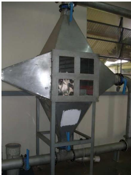
Figura 4.2 – Secador convectivo de fluxo paralelo e perpendicular.
