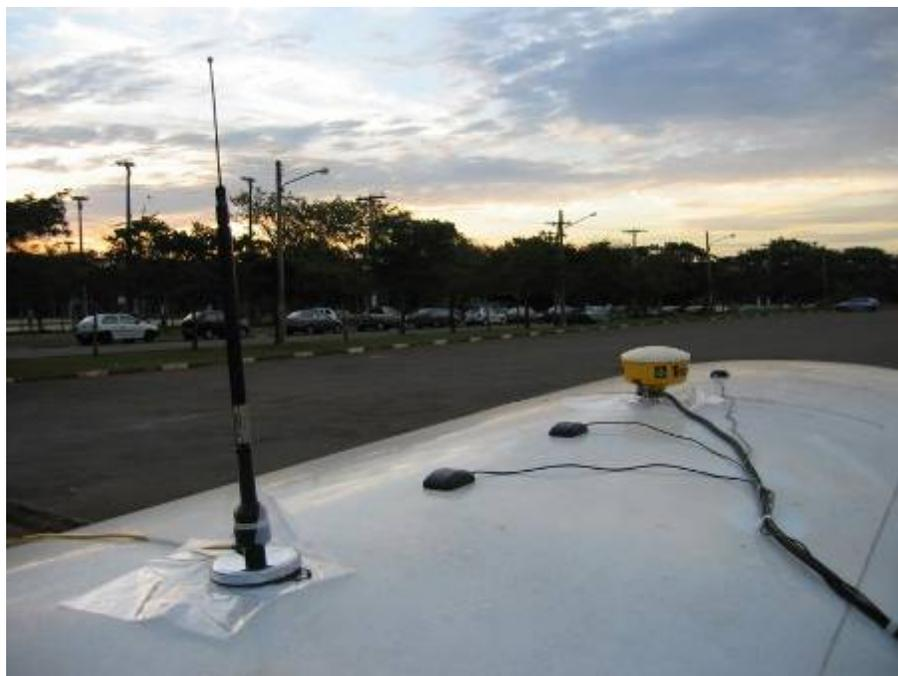
*Figura 46 – Antenas do receptor de rádio e receptores de GPS e do instaladas no teto do veículo*
