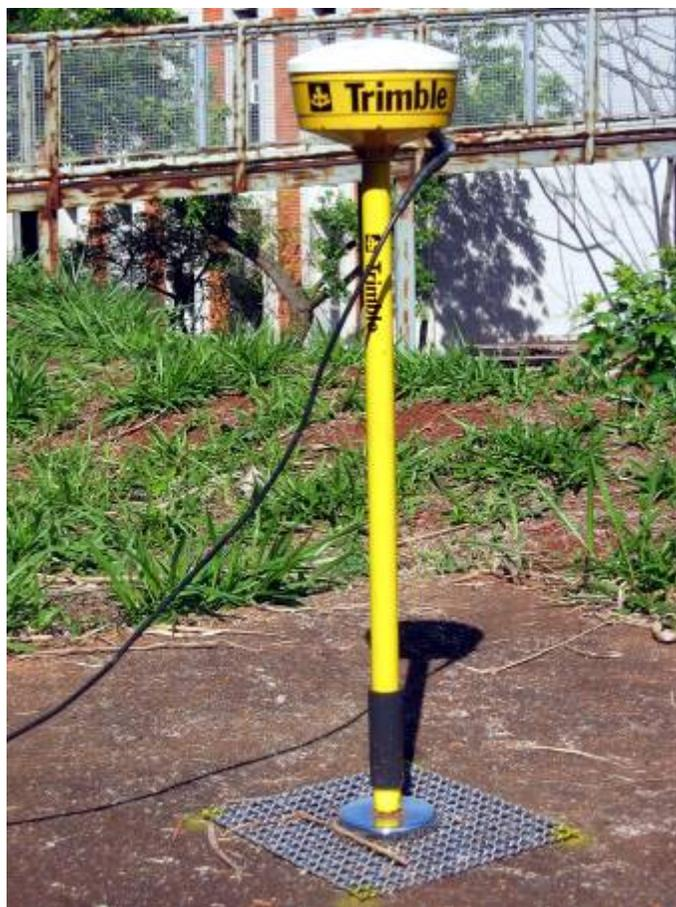
*Figura 39 – Antena utilizada para os receptores de GPS modelo III Plus*
