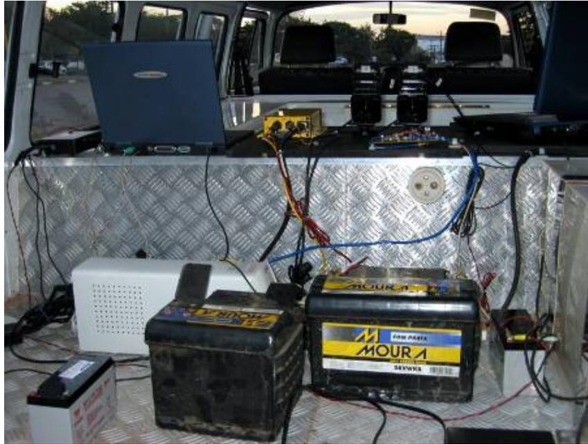
*Figura 45 – No-break e baterias utilizadas no veículo*
