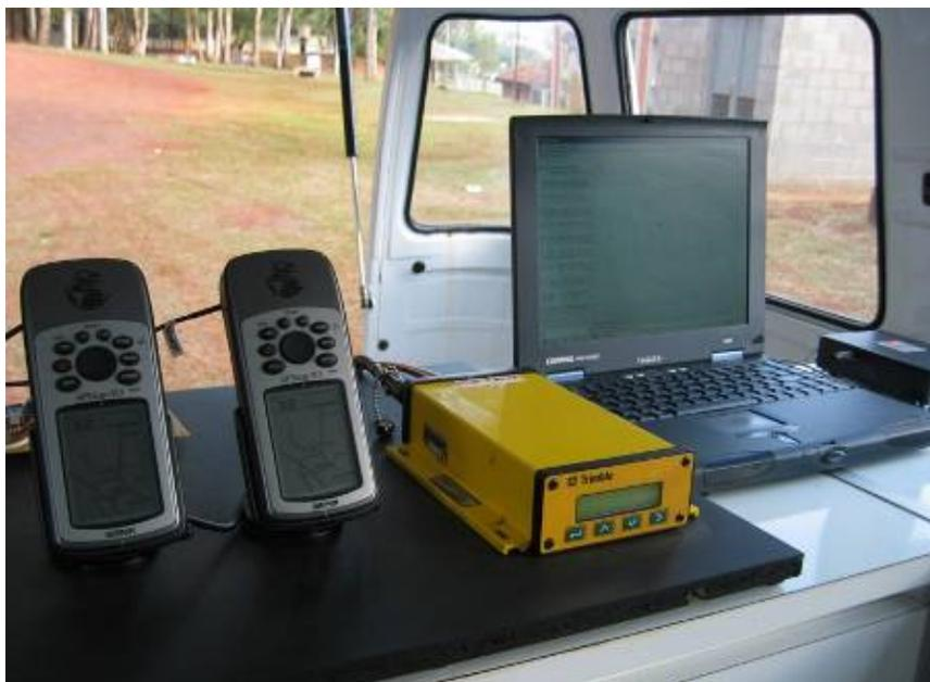
*Figura 44 – Equipamentos instalados no interior do veículo utilizado nos testes cinemáticos*
