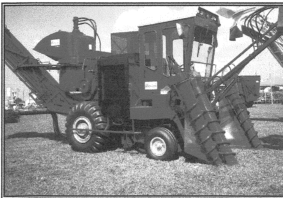
Figura 2 - Colhedora de cana-de-açúcar picada - mod. E-16000 (Brastoft).
