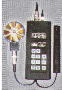
Figura 9. Hígro-termo-anemômetro, para registro da temperatura, umidade relativa e velocidade do ar.
