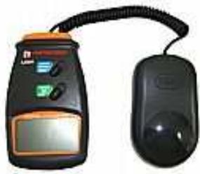
Figura 10. Luxímetro digital para registro da quantidade de luz.
