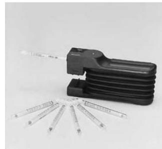
Figura 11. Bomba de sucção para detecção de gases com tubetes reagentes.
