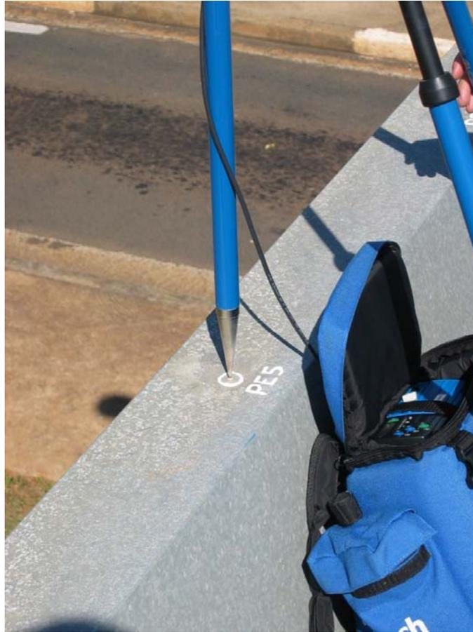
Figura 46 –Detalhe do de um dos marcos geo-referenciados.
