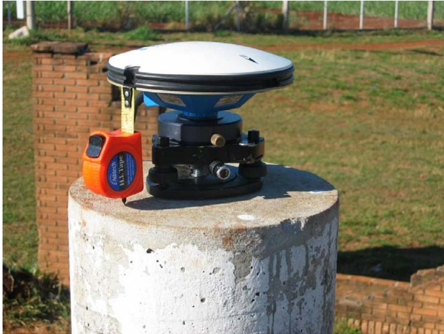
Figura 43 – Antena do equipamento Z-Xtreme instalada no marco da Rede de Referência Cadastral Municipal de Campinas.
