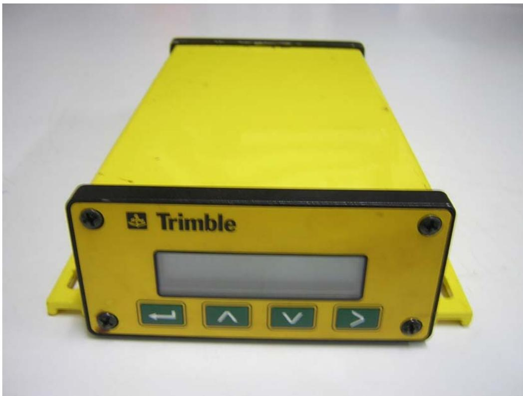
Figura 32 – Aparelho receptor de sinal de GPS, modelo AgGPS 132, marca Trimble.
