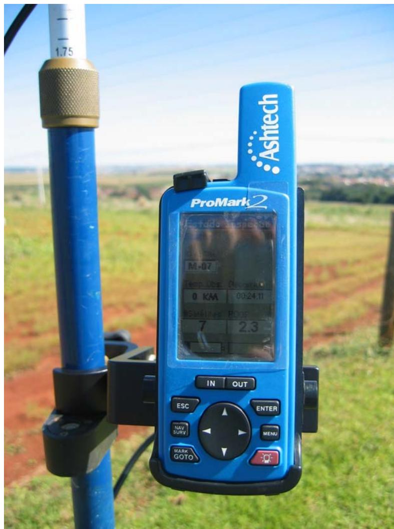
Figura 35 – Aparelho receptor de sinal de GPS, modelo ProMark 2, marca Thales Navigation.
