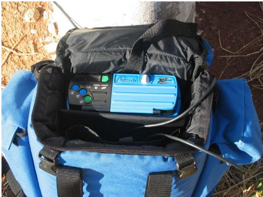
Figura 44 – Equipamento de GPS Z-Xtreme
