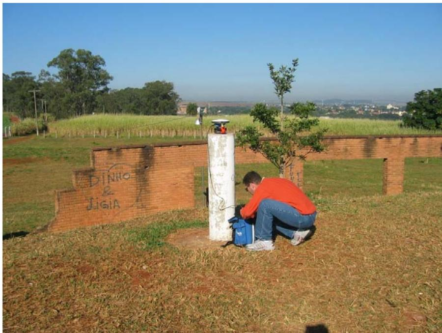
Figura 42 – Instalação do equipamento Z-Xtreme no marco da Rede de Referência Cadastral Municipal de Campinas.
