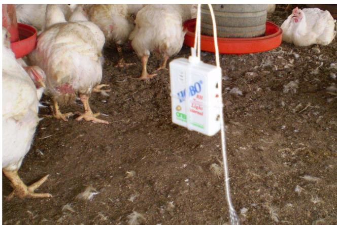
Figura 11. Equipamento HOBO® para coleta de temperatura e umidade relativa nas granjas A e B.
