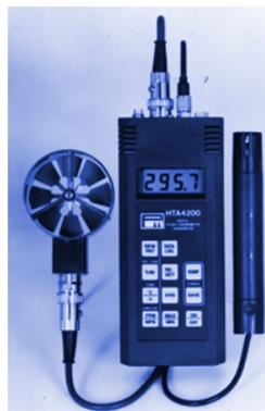
Figura 3. Termohigroanemômetro
