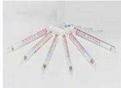
Figura 13. Tubo colorimétrico para detecção de amônia.
