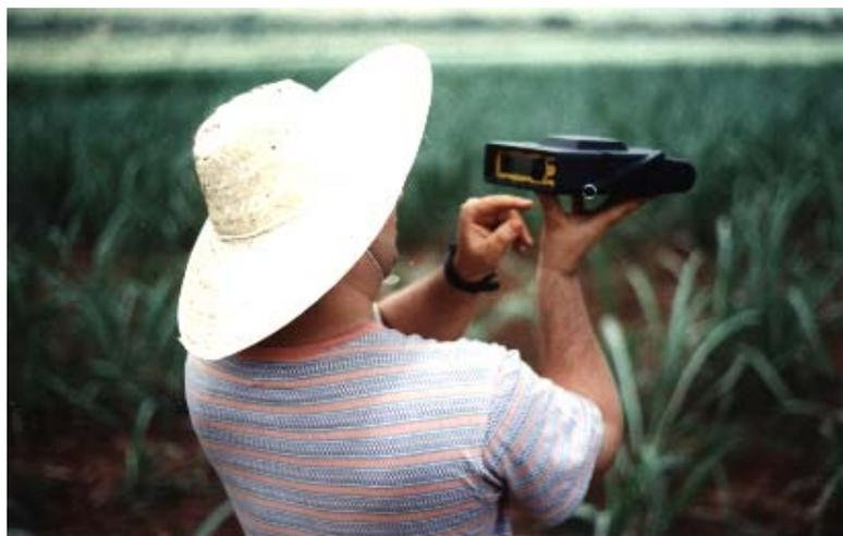
**Figura 1.** Determinação das coordenadas geográficas de uma das parcelas pertencentes à área de trabalho, usando o aparelho de GPS modelo Pathfinder Basic™ Receivers, fabricado pela Trimble Navigation, Ltd.
