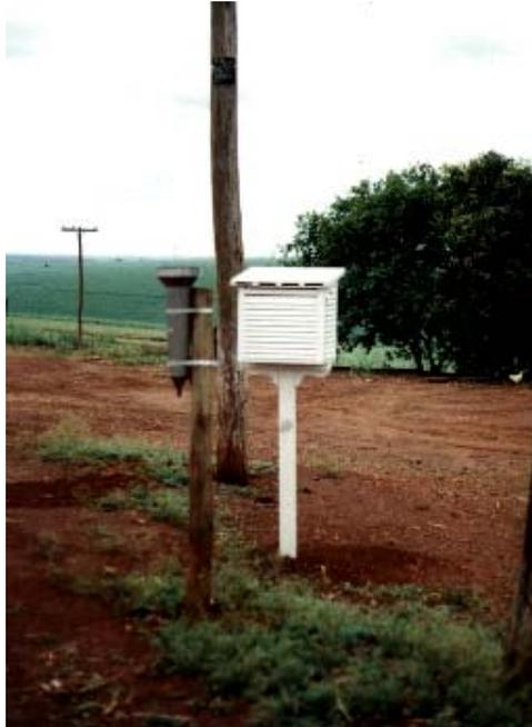
**Figura 3.** Pluviômetro e abrigo meteorológico contendo termógrafo e higrógrafo instalados em local próximo à área de trabalho.
