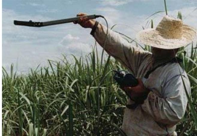
**Figura 9.** Medidas de proporção do solo descoberto ( $P_s$ ) e da proporção da cobertura pela vegetação ( $P_v$ ) feitas com o equipamento LAI-205016 *Optical Sensor*.
