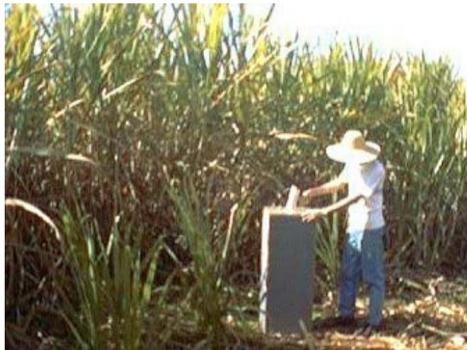
**Figura 8.** Medida de temperatura radiativa de uma amostra de cana rearranjada no solo sendo feita com a caixa pelo “método de uma tampa”.
