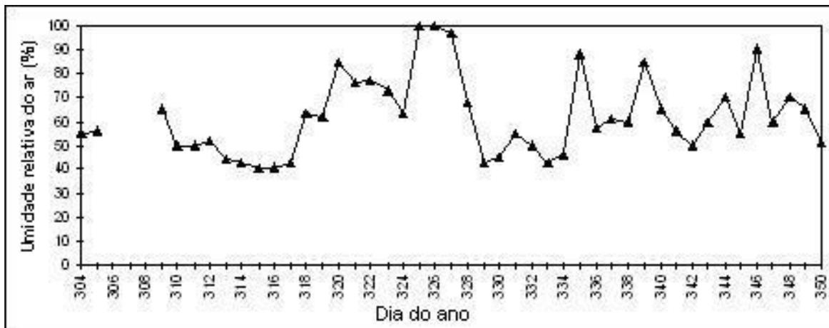
**Figura 20.** Dados coletados durante o período de 29 de outubro a 14 de dezembro de 1996 pelo higrógrafo instalado em abrigo meteorológico.
