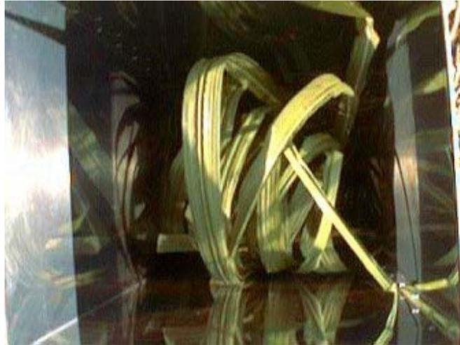
**Figura 7.** Amostra de cana posicionada dentro da caixa de alumínio polido.
