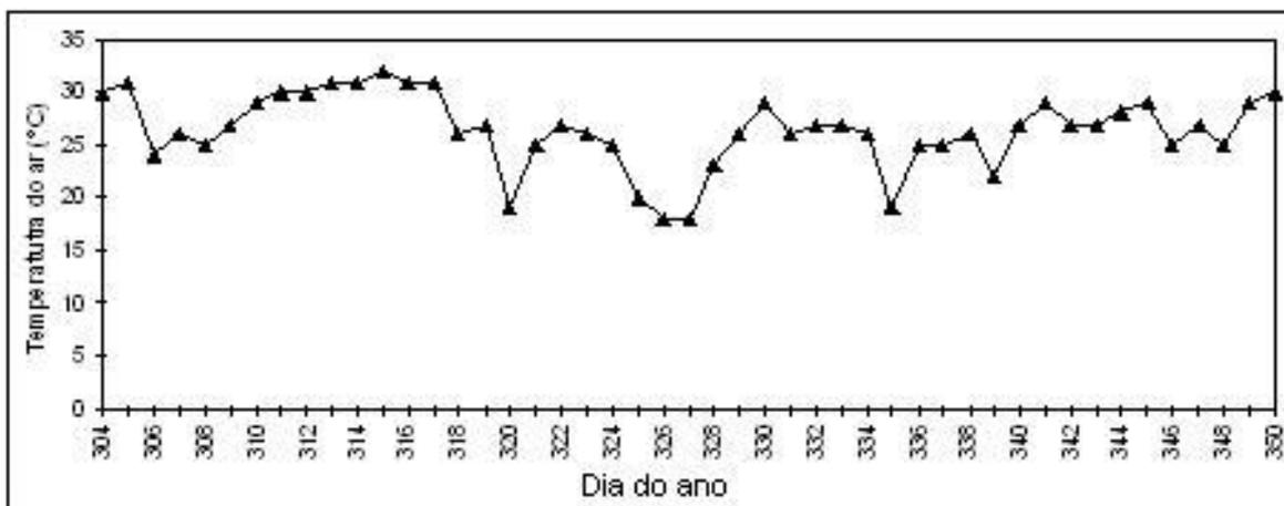
**Figura 19.** Dados coletados durante o período de 29 de outubro a 14 de dezembro de 1996 pelo termógrafo instalado em abrigo meteorológico.
