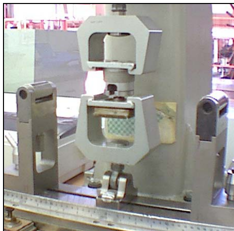
Figura 3.31 – Fotografia do ensaio para determinação do módulo de resistência à tração superficial
