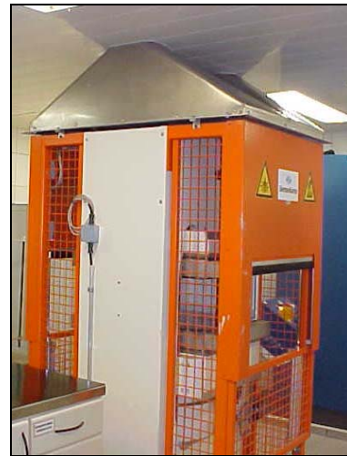
Figura 3.11 - Aspectos gerais da prensa para confecção das chapas com controle de temperatura e pressão
