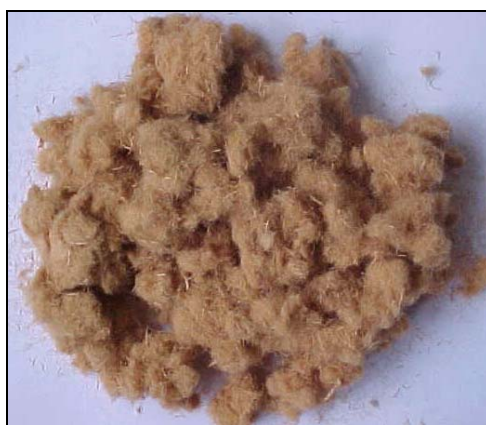
Figura 3.1 – Fotografia das fibras de Pinus caribaea utilizadas na confecção das chapas
