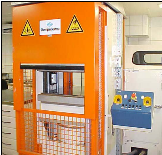
Figura 3.11 - Aspectos gerais da prensa para confecção das chapas com controle de temperatura e pressão
