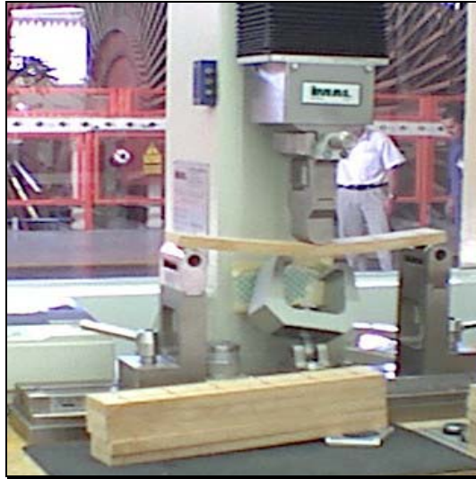
Figura 3.29 – Fotografia do ensaio para determinação do módulo de resistência à flexão estática
