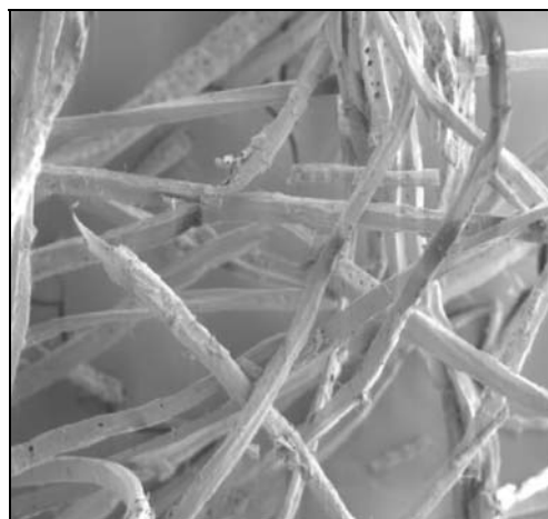
Figura 3.3 – Fotografia microscópica das fibras de Pinus caribaea utilizadas na confecção das chapas
