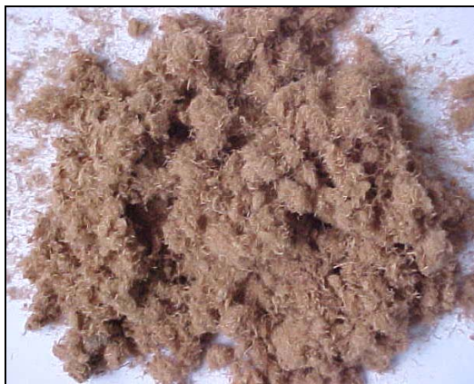
Figura 3.2 – Fotografia das fibras de Eucalyptus grandis utilizadas na confecção das chapas
