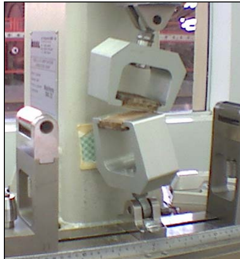
Figura 3.30 – Fotografia do ensaio para determinação do módulo de resistência à tração perpendicular
