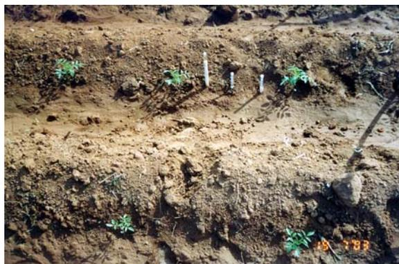
**Figura 4: Tensiômetros posicionados entre pés de tomate em três profundidades**
