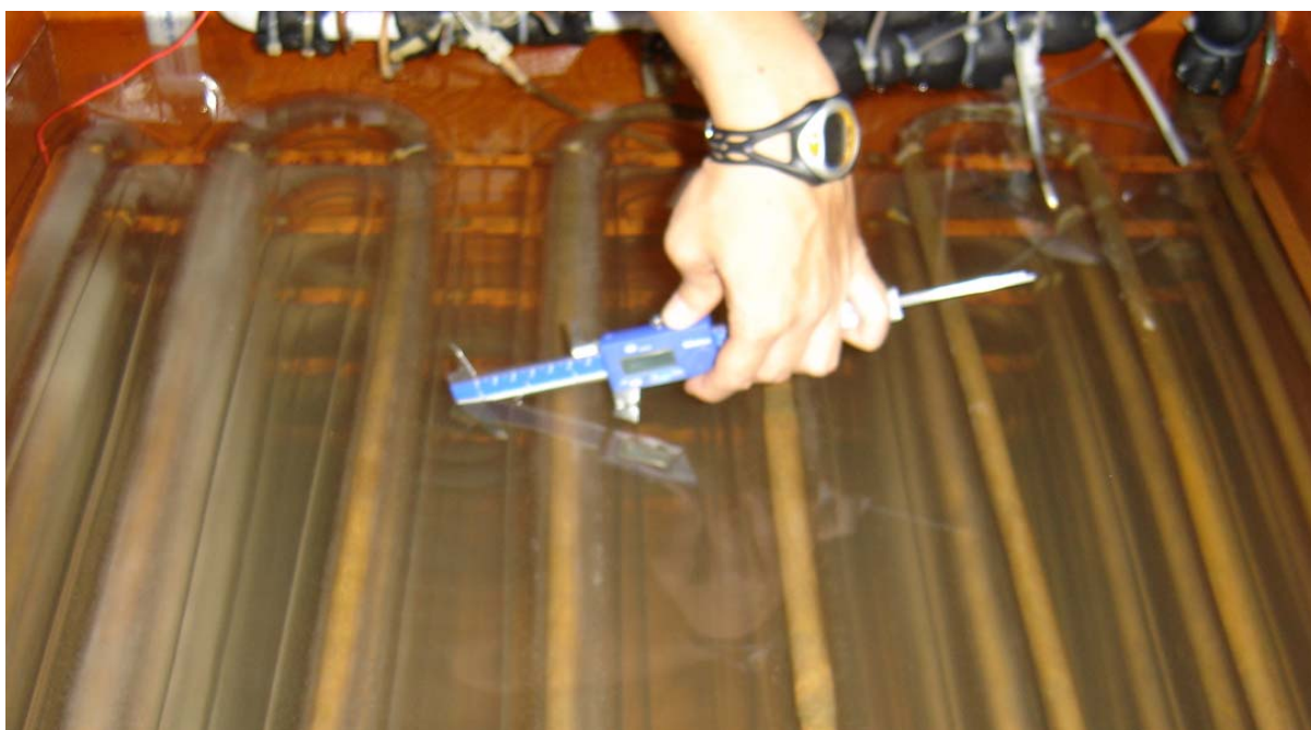
Figura 34. Paquímetro digital usado para medição do diâmetro de gelo formado no evaporador da bomba de calor “B1”.
