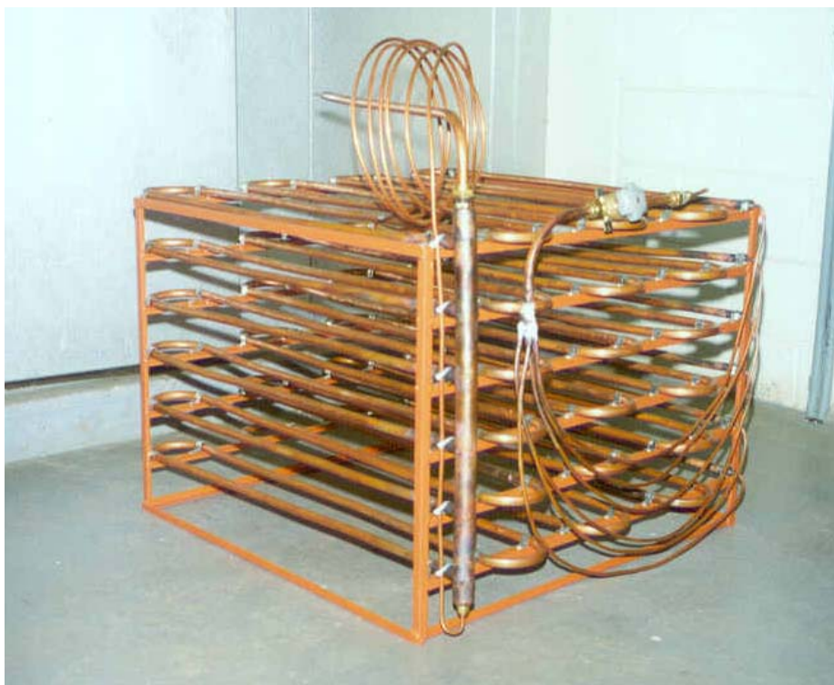
Figura 9. Evaporador montado para o banco de gelo da bomba de calor “B1”.
