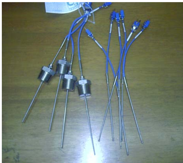
Figura 22. Termopares com isolamento mineral, com pote liso e pote com rosca para conexão nas tubulações dos trocadores de calor.
