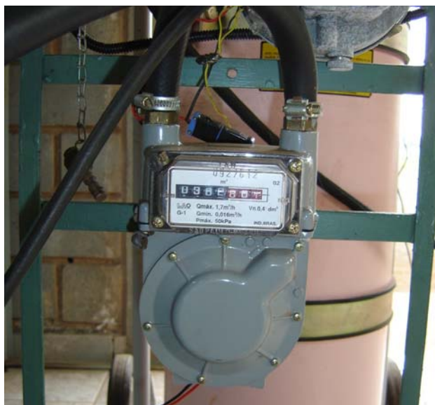
Figura 32. Medidor mecânico usado para medição do consumo de gás.
