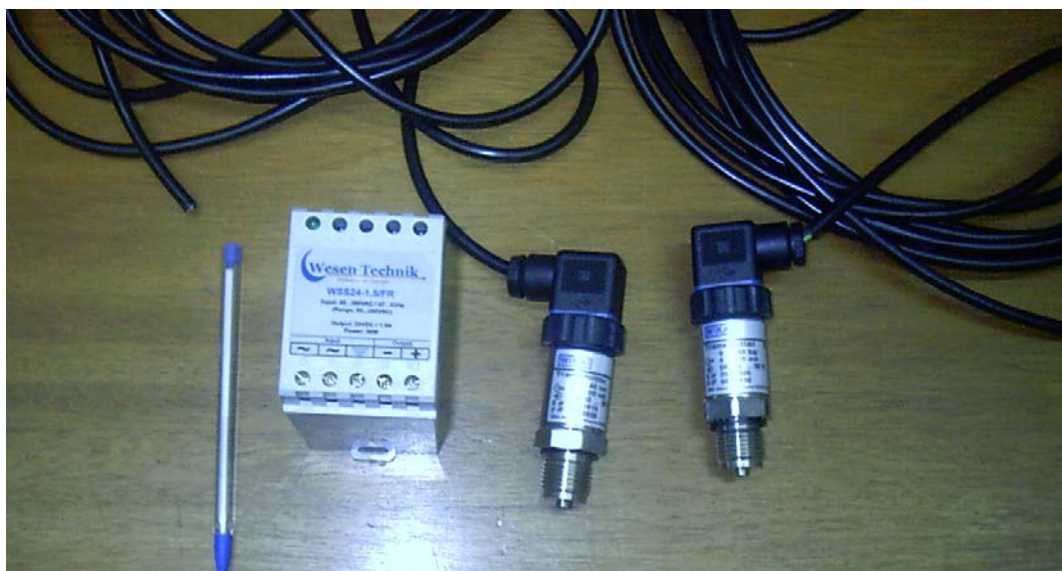
Figura 24. Fonte de alimentação e transmissores de pressão utilizados para medição de pressão do circuito frigorífico das bombas de calor.
