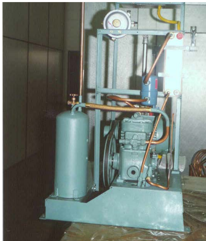
Figura 12. Protótipo “B1”: fase de montagem dos componentes de refrigeração.
