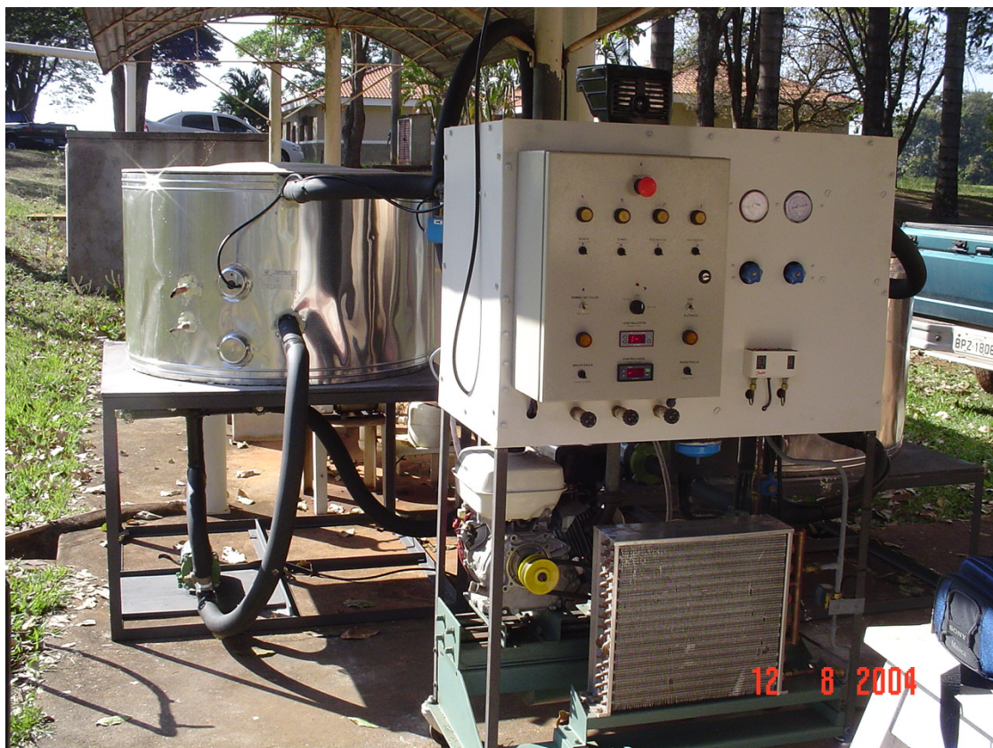
Figura 21. Bomba de calor “B2” instalada em Jaboticabal para testes com biogás.
