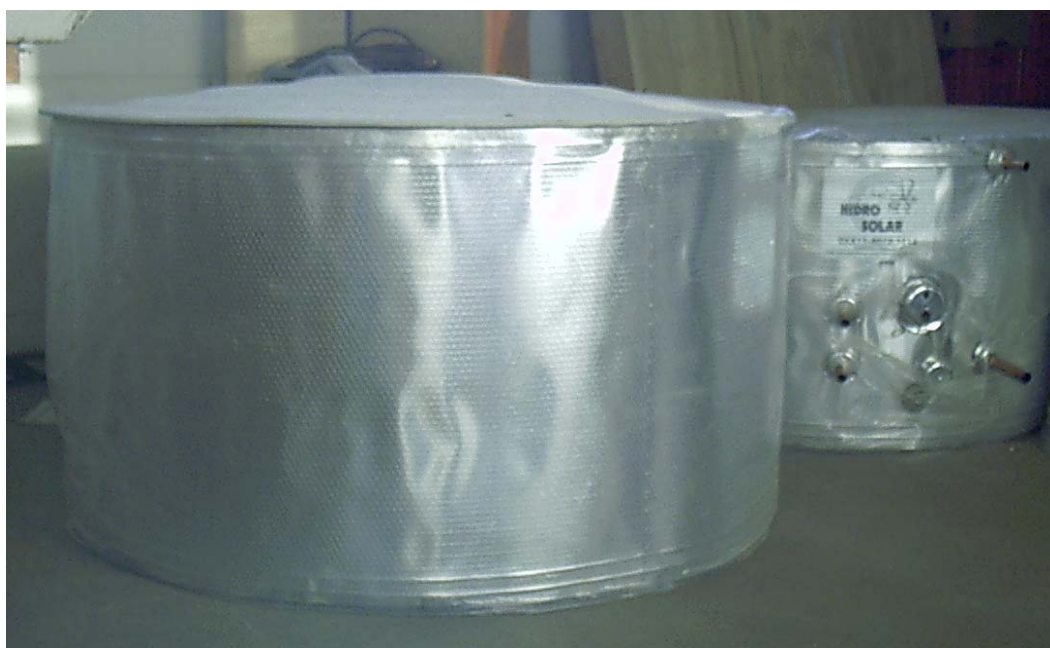
Figura 15. Tanque de 1000 litros para acumulação de solução de água-álcool e ao fundo, tanque de 500 litros para acumulação de água quente, usados para o protótipo “B3”.
