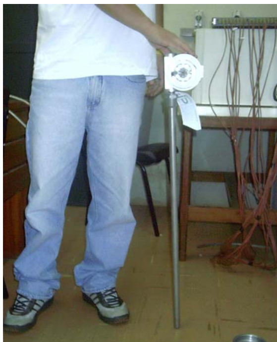
Figura 23. Termopar conjugado ou tipo poço utilizado para medição da variação da temperatura nos reservatórios térmicos.
