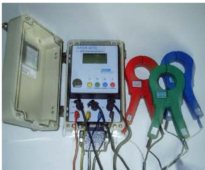
Figura 31. Medidor Eletrônico Digital ESB Medidores, família SAGA 4000, Modelo 1380.
