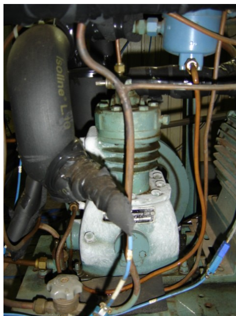
Figura 43. Congelamento do cárter do compressor da bomba de calor “B1” durante um ensaio com superaquecimento zero, evidenciando retorno de líquido.
