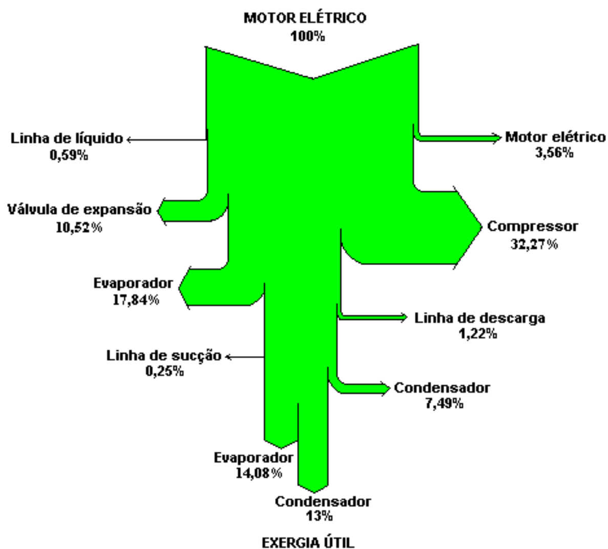
Figura 72. Diagrama dos fluxos médios de exergia para a bomba de calor "B1" nas condições nominais de operação, acionada com motor elétrico.
