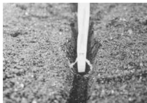
Figura 10 - A) Dispositivo de aplicação de fertilizante líquido no solo utilizando haste flexível. B) Detalhe da haste flexível (BRAGACHINI et al., 2001)
