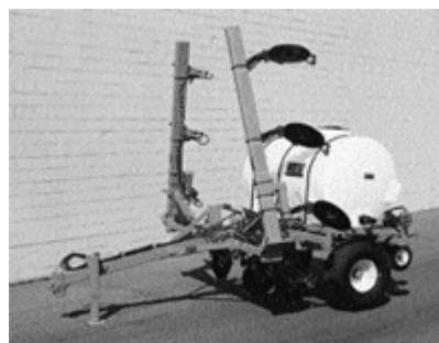
Figura 31 - A) Sistema de aplicação de fertilizantes líquidos, Coulter Knife Injection Applicator, da KBH Corp, com os aplicadores instalados na traseira do implemento. B) Outro implemento, o Front-Mount Toolbar Applicator, do mesmo fabricante, com os aplicadores instalados a frente do reservatório de fertilizante (DEALER AND APPLICATOR, 2003)
