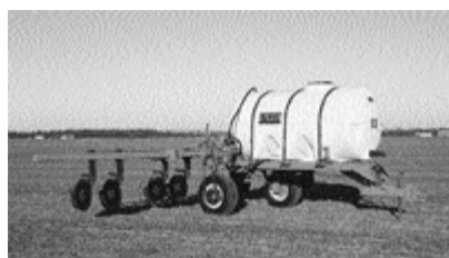
Figura 31 - A) Sistema de aplicação de fertilizantes líquidos, Coulter Knife Injection Applicator, da KBH Corp, com os aplicadores instalados na traseira do implemento. B) Outro implemento, o Front-Mount Toolbar Applicator, do mesmo fabricante, com os aplicadores instalados a frente do reservatório de fertilizante (DEALER AND APPLICATOR, 2003)
