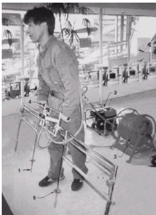
Figura 8 - Sistema para a aplicação pontual de nitrogênio fluído (BAUTISTA et al., 2001)
