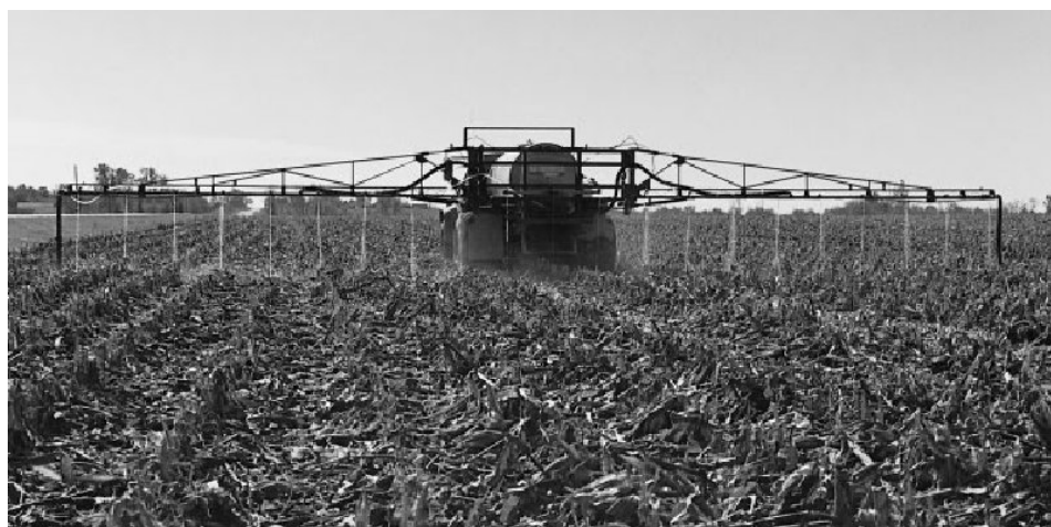
Figura 15 - Sistema autopropelido, onde um caminhão é adaptado para receber um reservatório de alta capacidade mais o sistema de aplicação (SPRAYING SYSTEMS, 2004)
