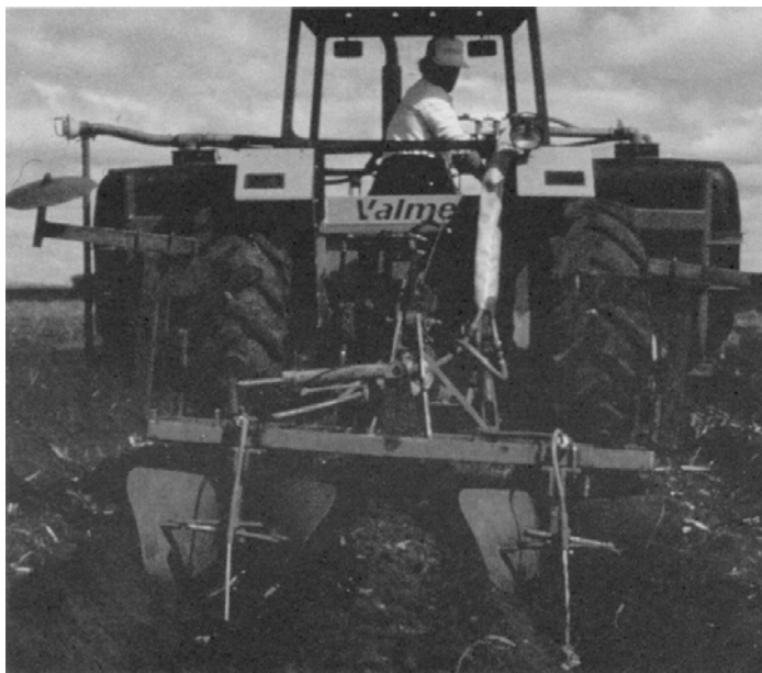
Figura 14 - Reservatório localizado na parte lateral do trator (ARAÚJO FILHO, 1994)
