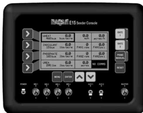
Figura 28 - Console de controle EAGLE E15, para a aplicação de até quatro insumos diferentes a taxas fixas. Também aplica a taxas variáveis recebendo as informações de um controlador externo do mesmo fabricante (KEE TECHNOLOGIES, 2005)
