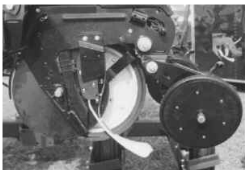
Figura 10 - A) Dispositivo de aplicação de fertilizante líquido no solo utilizando haste flexível. B) Detalhe da haste flexível (BRAGACHINI et al., 2001)
