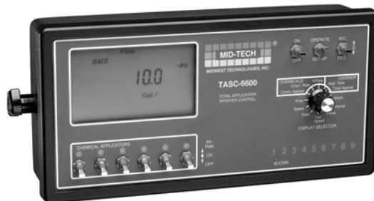
Figura 25 - Central de controle para a aplicação de fertilizantes líquidos a taxa fixa, também variando a formulação através de nutrientes diluídos em água. Também aplica a taxas variáveis recebendo as informações através de um computador externo (MIDWEST TECHNOLOGY, 2003)
