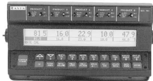
Figura 27 - Central de controle SCS 760, para a aplicação de fertilizantes líquidos a taxa fixa, também variando a formulação através de nutrientes diluídos em água. Aplica a taxas variáveis recebendo as informações através de um computador externo (RAVEN INDUSTRIES, 2003)
