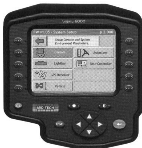
Figura 26 - Console do sistema Legacy 6000, da Midwest Technology, efetua diversas funções simultaneamente, aplicação a taxas variáveis, piloto automático, controle de navegação e mapeamento em tempo real (Spraying Systems, 2004)
