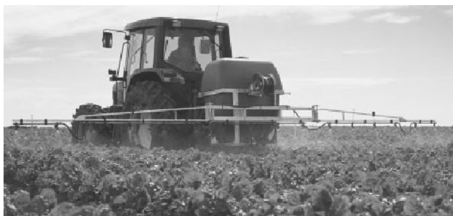
Figura 12 - Reservatório acoplado a barra porta-ferramentas do trator (SPRAYING SYSTEMS, 2004)
