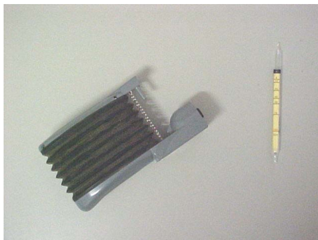
Figura 27. Bomba e tubeta para medição da concentração de amônia.
