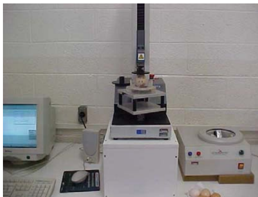
Figura 18. Máquina universal de ensaios de Tração e Compressão.
