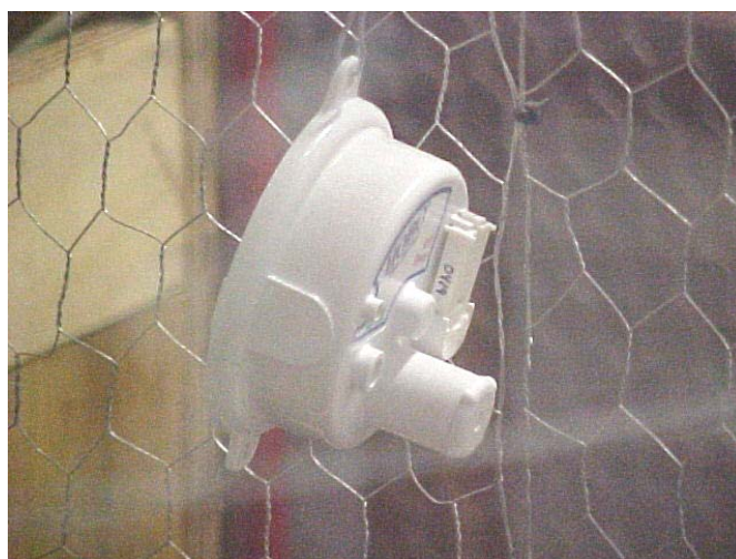
Figura 11. Termohigrometro Hobo® instalado no box.
