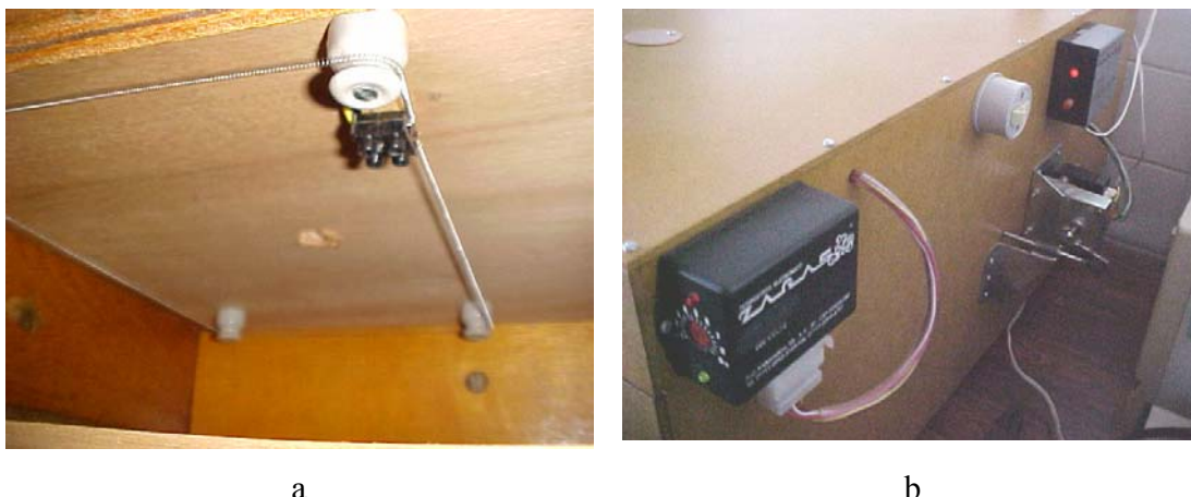
Figura 29. Detalhe da resistência para aquecimento, do termostato e do sistema de viragem dos ovos.
