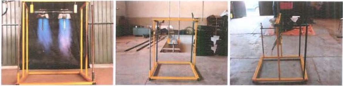
Figura 9. Detalhes da possibilidade de montagem com dois queimadores, altura em relação à superfície e inclinação.
