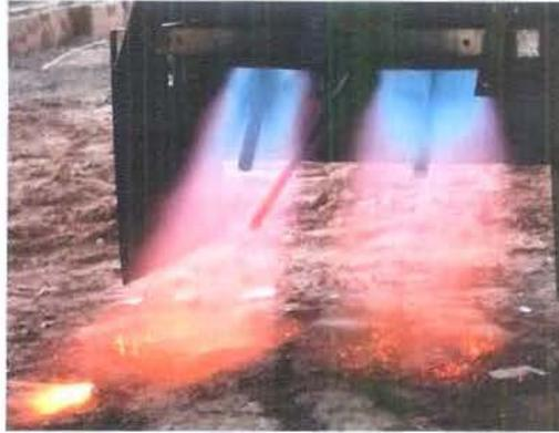
Figura 33. Termopar posicionado na unidade flamejadora para medição contínua de temperatura durante o deslocamento da ponte rolante para aplicação dos tratamentos.
