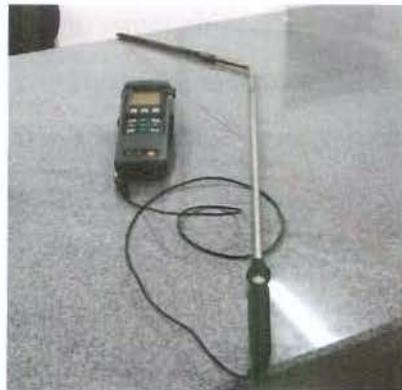
Figura 23. Sonda de Temperatura de até 1250°C e instrumento (Data Logger) Testo 400 para aquisição e armazenamento dos dados.
