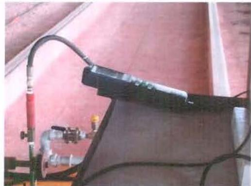
Figura 34. Detalhe do termo-higrômetro, anemômetro e data logger.
