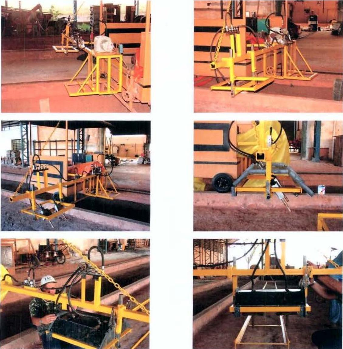
Figura 10. Montagem da estrutura na barra porta ferramentas da ponte rolante.
