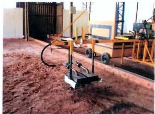
Figura 19. Modelo experimental de flamejador do tipo infravermelho.
