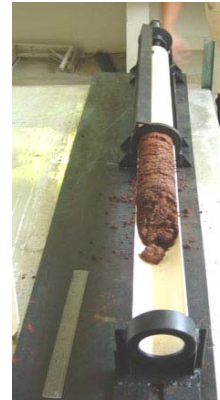
Figura 16. Detalhes do procedimento de remoção de amostras de solo (“Saca amostra”).
