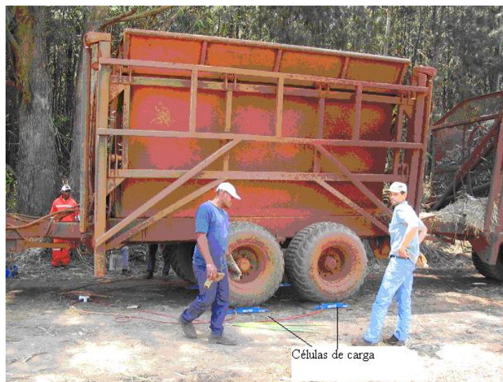
Figura 35. Pesagem do transbordo utilizando células e carga.
