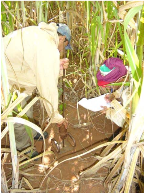
Figura 13. Determinação da resistência do solo à penetração.
