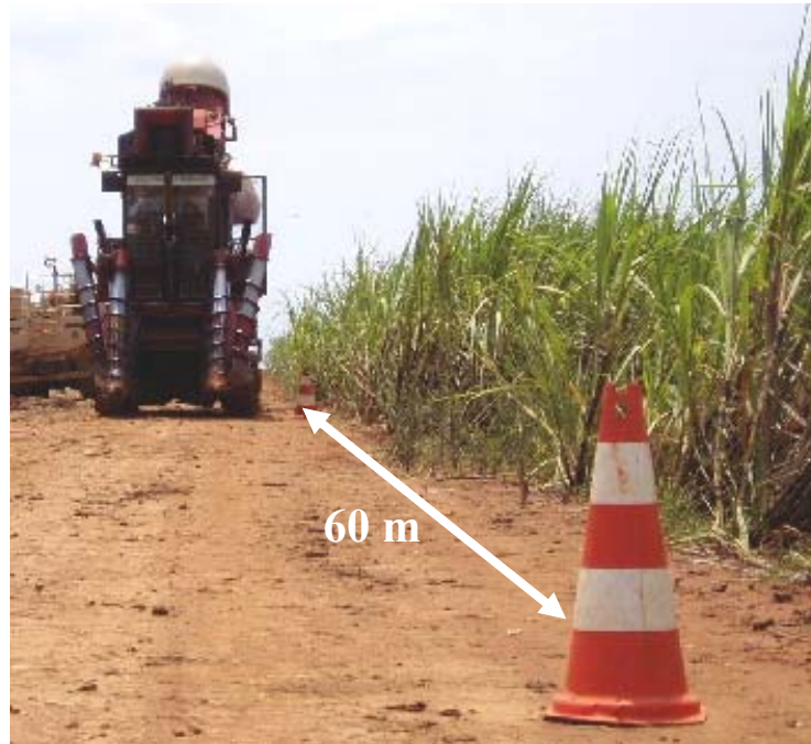
Figura 51. Calibração do sensor de velocidade da colhedora em condições de campo.
