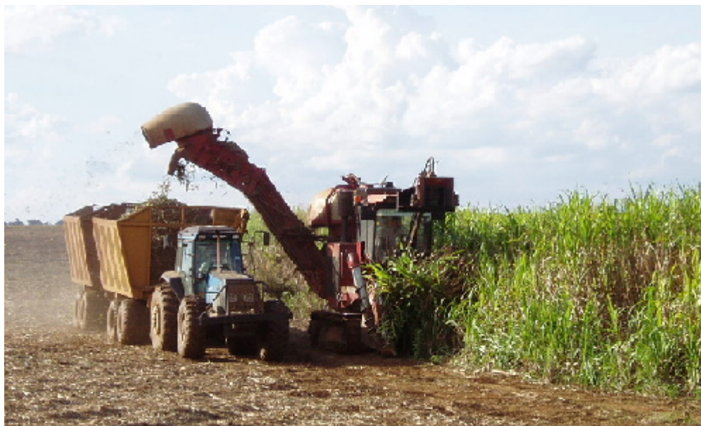
Figura 58. Colhedora em operação e transferência da cana para o conjunto de transbordos.
