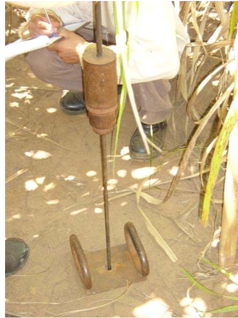
Figura 13. Determinação da resistência do solo à penetração.
