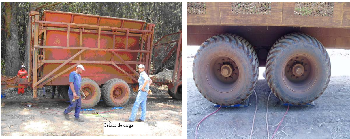
Figura 59. Pesagem do transbordo utilizando células e carga.
