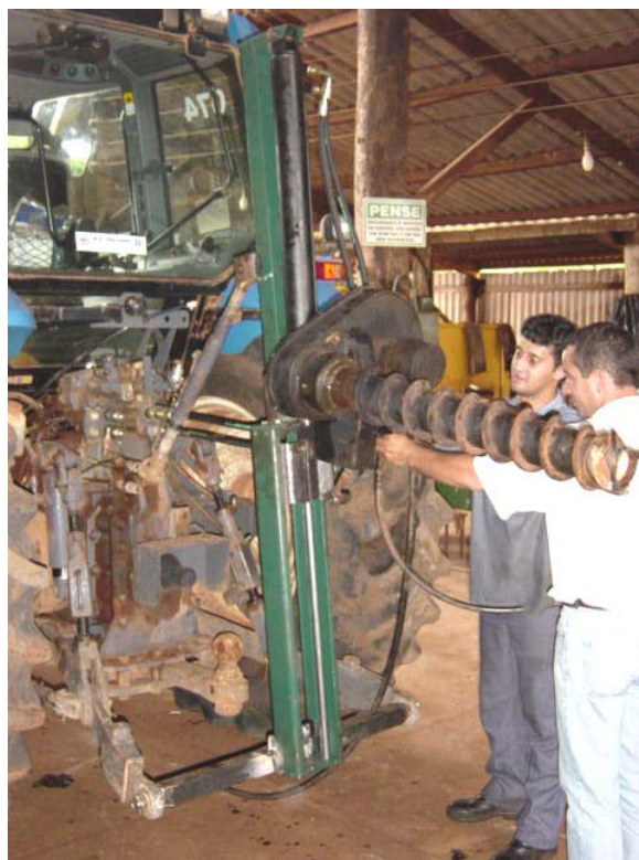
Figura 10. Amostrador de solo montado nos três pontos do trator.
