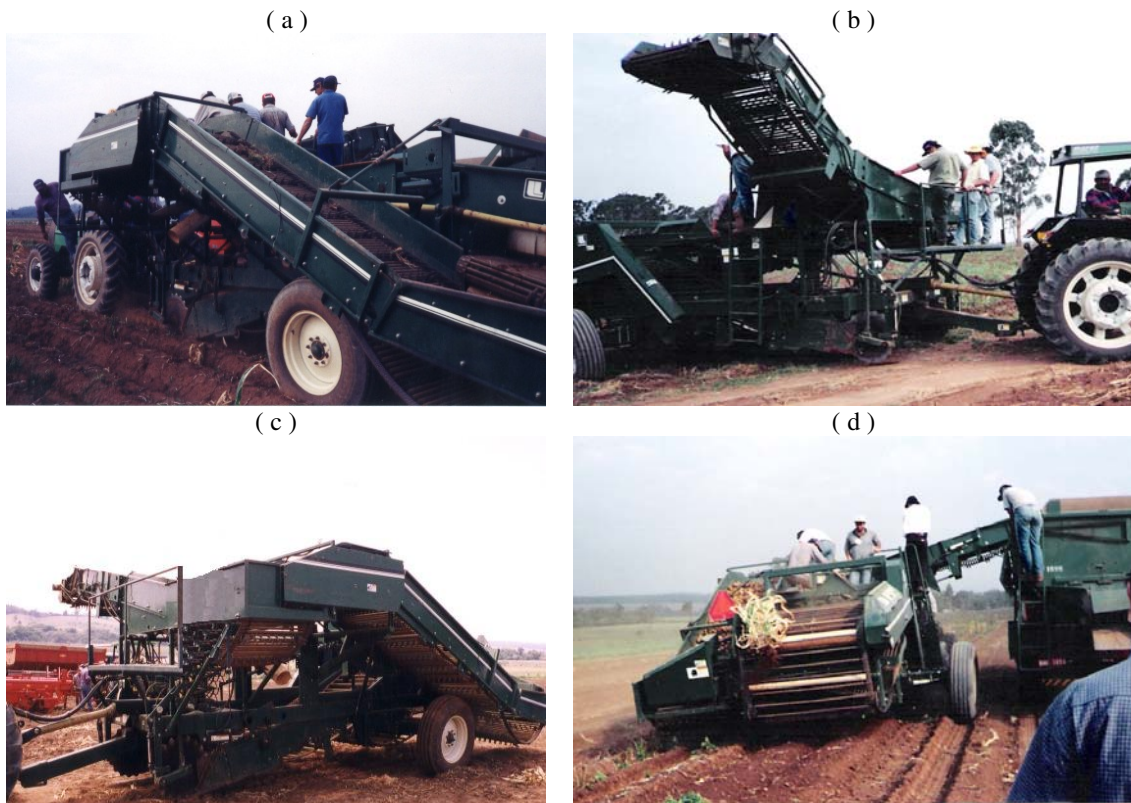
( a ) : Vista geral da área de trabalho; ( b ) : Sistema de descaga; ( c ) : Visão geral da colhedora; ( d ) : Visão do sistema de separação de plantas daninhas.
