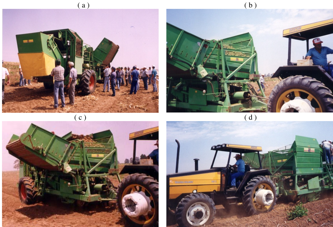
( a ) : Agricultores analisando a colhedora; ( b ) : Acoplamento da colhedora ao trator; ( c ) : Sistema de descarga; ( d ) : Colhedora em operação.
