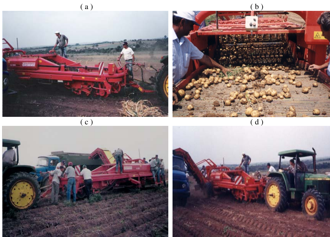
( a ) : Agricultores analisando a colhedora; ( b ) : Esteira para separação de torrão; ( c ) : Agricultores analisando a colhedora; ( d ) : Colhedora em operação.
