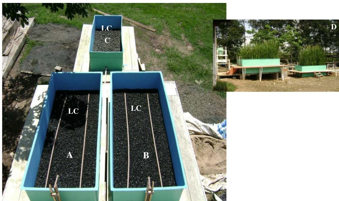
**Figura 12.** Disposição dos leitos cultivados com macrófitas. (A) e (B) leitos de fluxo vertical com a tubulação de distribuição não suspensa, (C) leito de fluxo horizontal, (D) detalhe ressaltando o desnível dos LCFVs em relação ao LCFH.
