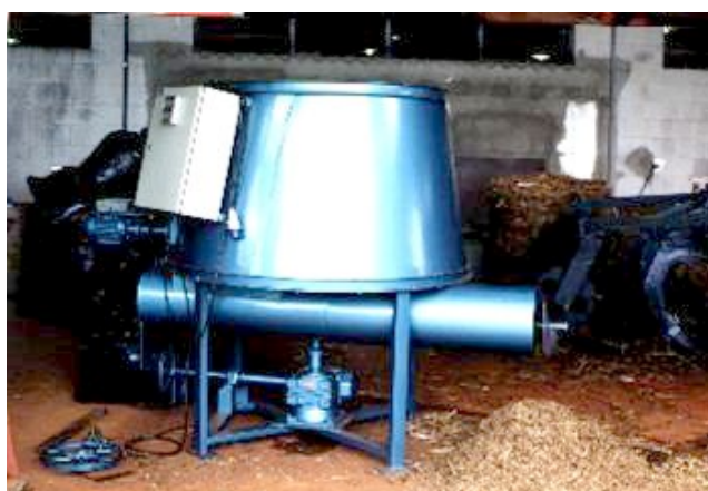
Figura 8. Protótipo de picador de fardo.
