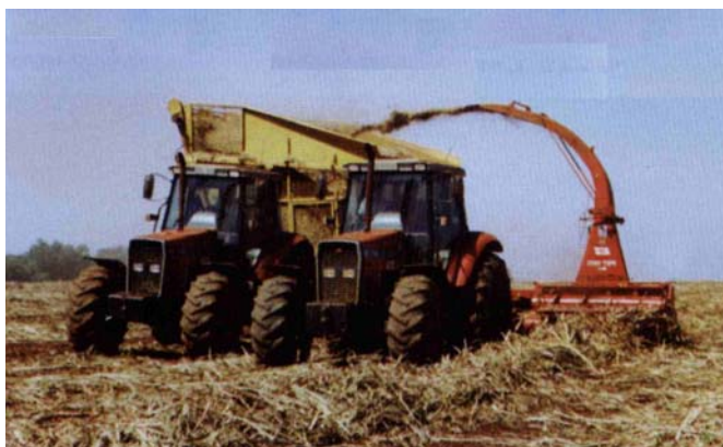
Figura 10. Recolhedora de forragens recolhendo o palhiço enleirado.
