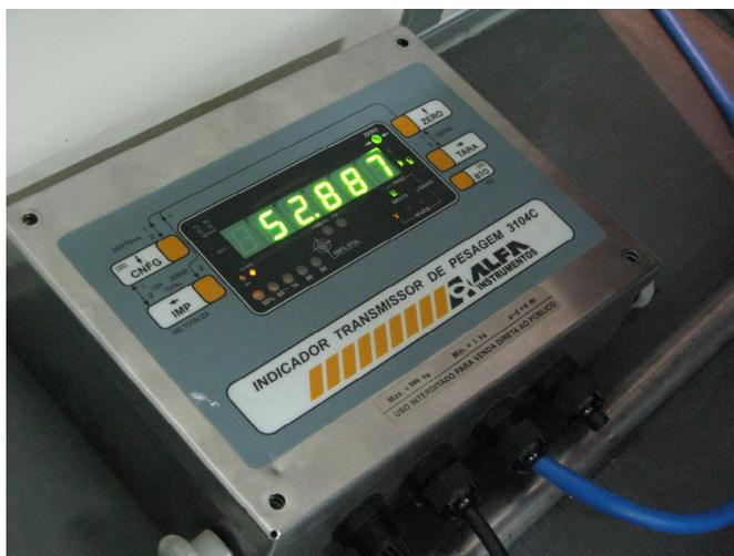
Figura 17. Indicador transmissor de pesagem
