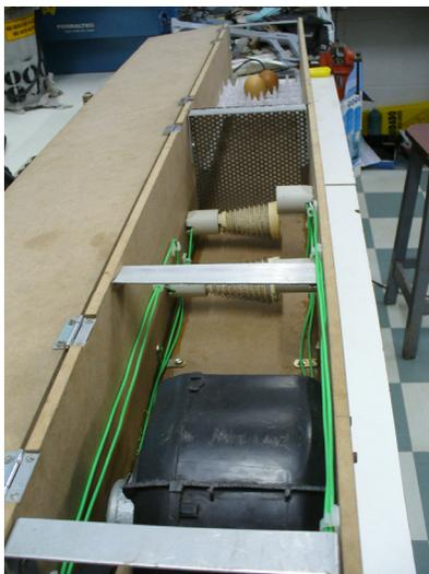
Figura 24. Ventilador centrífugo e banco de resistências
