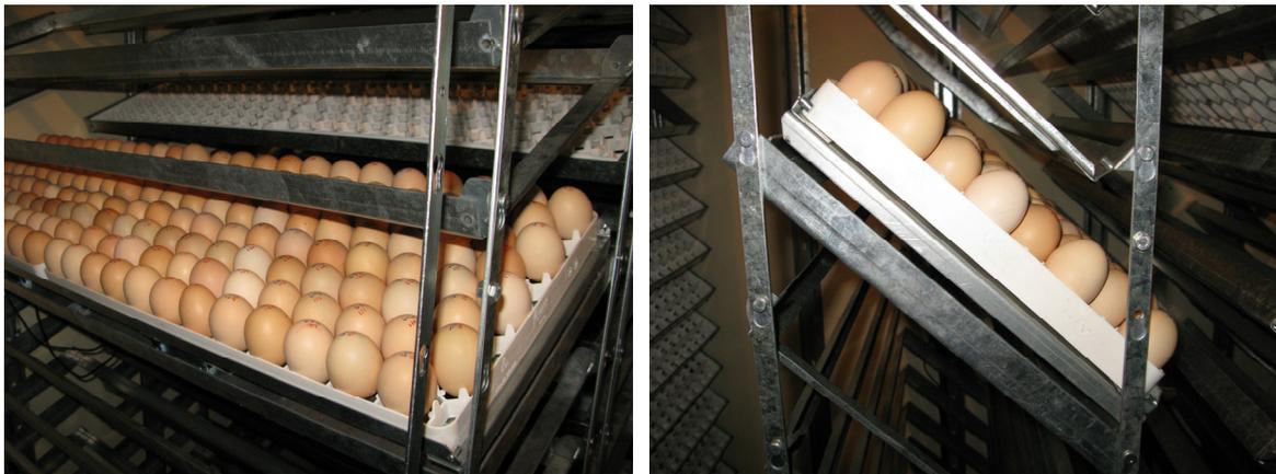
**Figura 8. Viragem dos ovos em uma máquina incubadora.**
