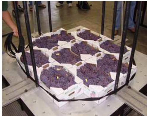
*Figura 24 - Fixação das caixas na mesa vibratória*
