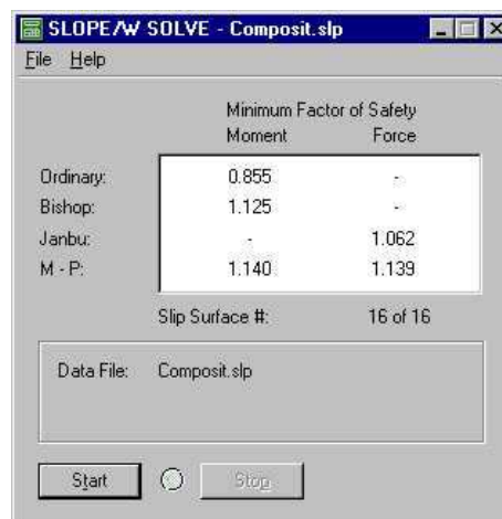
Figura 39. Determinação dos fatores de segurança de uma seção.
