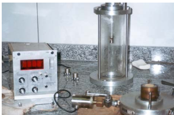
Figura 25. Câmara triaxial desmontada (notar o transdutor utilizado acoplado para verificação das pressões neutras).
