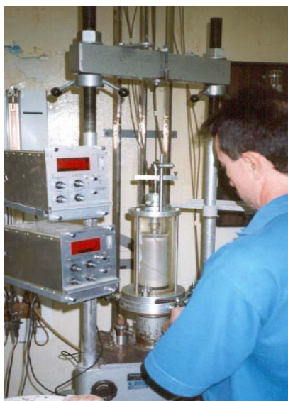
Figura 28 Colocação da câmara na prensa.
