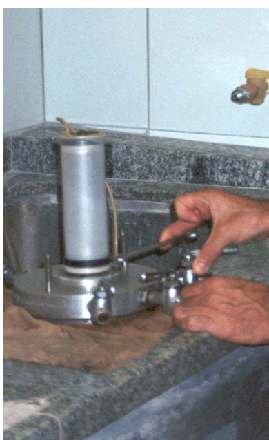
Figura 26. Posicionamento do corpo de prova de prova na base .
