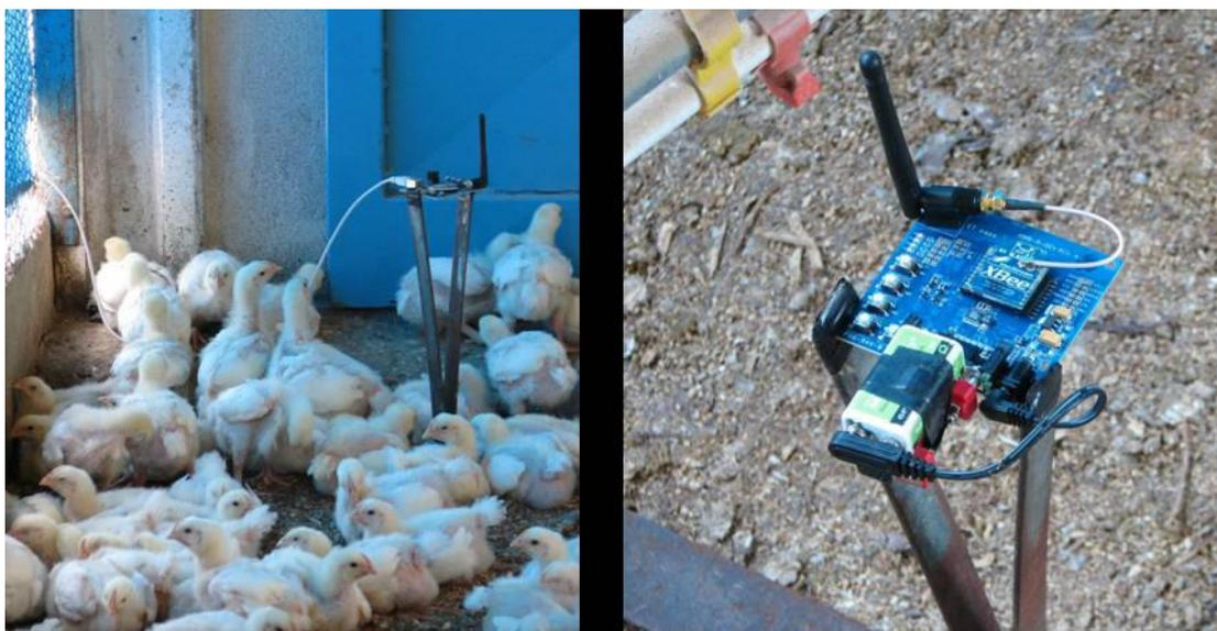
*Figura 29 – Dispositivos Xbee dentro da granja, conectado ao computador (esquerda) e dispositivo móvel (direita)*
