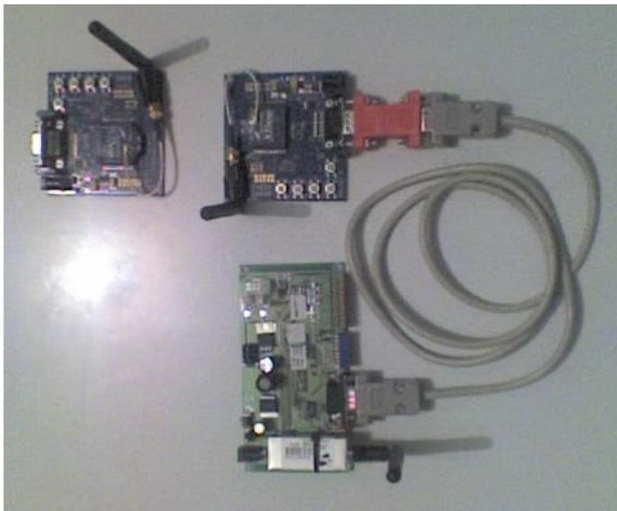
*Figura 23 – Componentes integrados*
