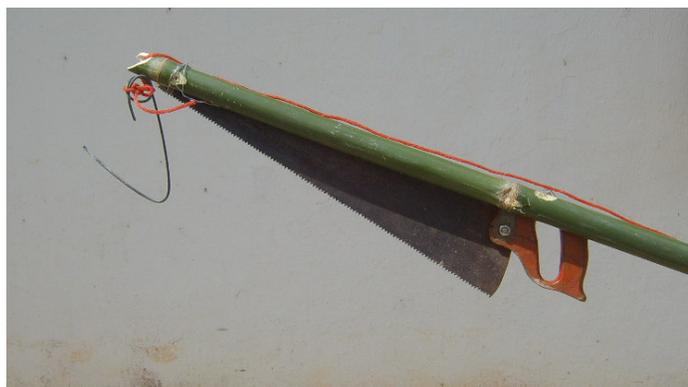
**Figura 33 – Adaptação de serrote em bambu para corte de cachos**
