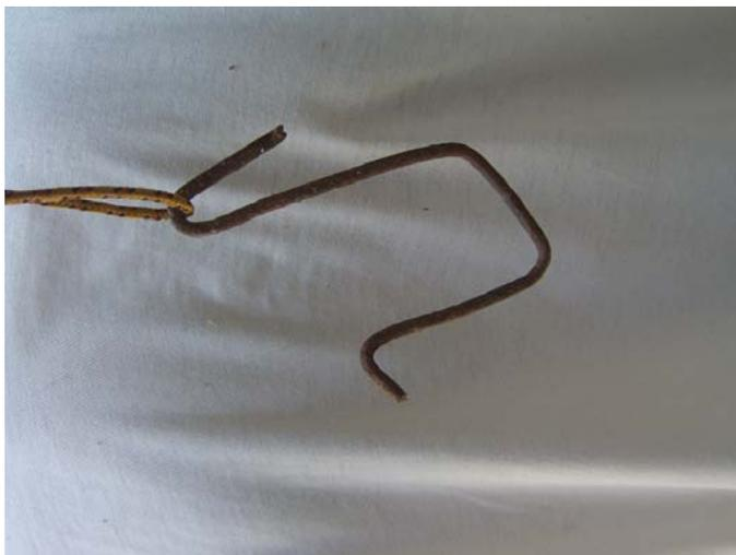
**Figura 20 – Gancho preso na extremidade da corda para descer o cacho**
