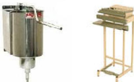
**Figura 13- Dosadora manual Tortugan e Seladora Térmica Acionada por Pedal**
