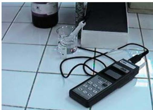
*Figura 21* – Aparelho HD NC 06 ONDA de leitura direta da condutividade elétrica para as amostras de água residuária.
