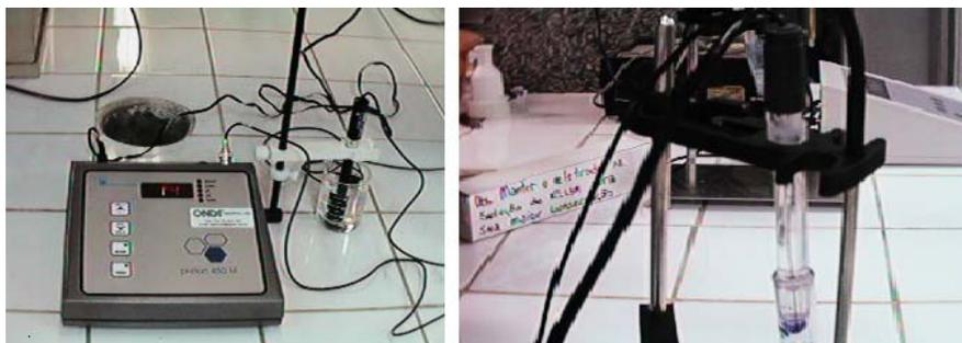
**Figura 19** – Foto do aparelho ANALYSER PH/ION 450M de leitura (em mV) de amônia e nitrato. Em destaque um dos eletrodos usados na leitura.
