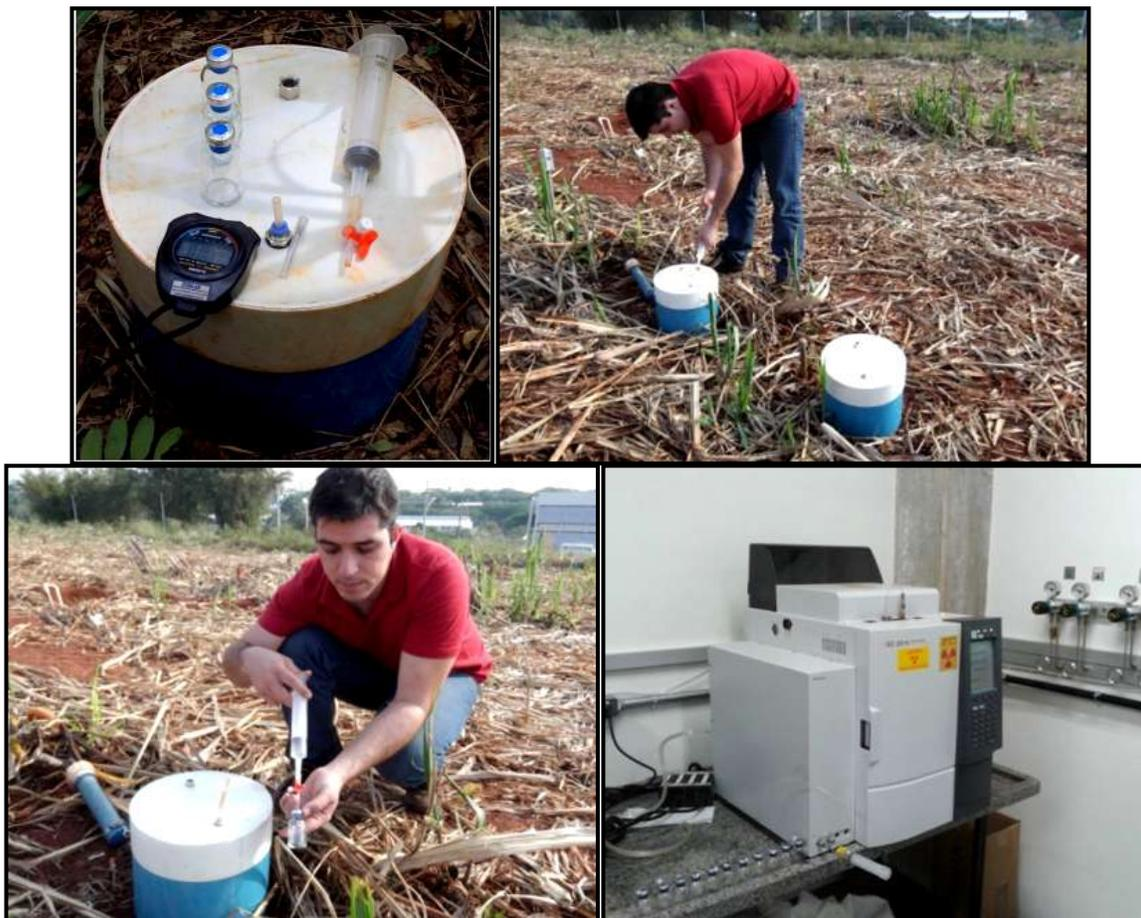
**Figura 34** - Esquema da coleta e leitura do óxido nítrico e metano. Instrumentos utilizados na coleta (esquerda, superior), Visão geral das câmara estática no campo e coleta dos gases em seringa de 60 mL (direita, superior), Armazenamento da amostra de gás em fresco de 20 mL (esquerda, inferior), e análise no cromatógrafo da UFSCar/Sorocaba (direita, inferior).
