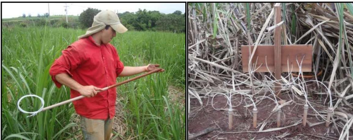
**Figura 32** - Instalação dos extratores de solução do solo (esquerda e centro) e visão geral dos extratores no campo.
