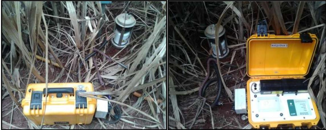
**Figura 33** - Câmera estática, anéis para acoplar a câmera do IRGA e TDR (Esquerda), coleta de CO<sub>2</sub> e visão geral do IRGA.
