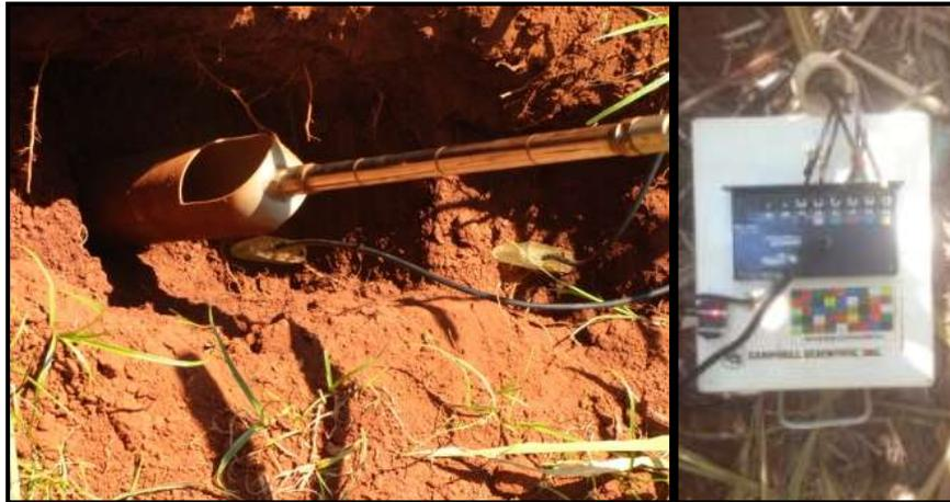
**Figura 30** - Instalação das sondas TDR e coleta do dados de umidade com o TDR.
