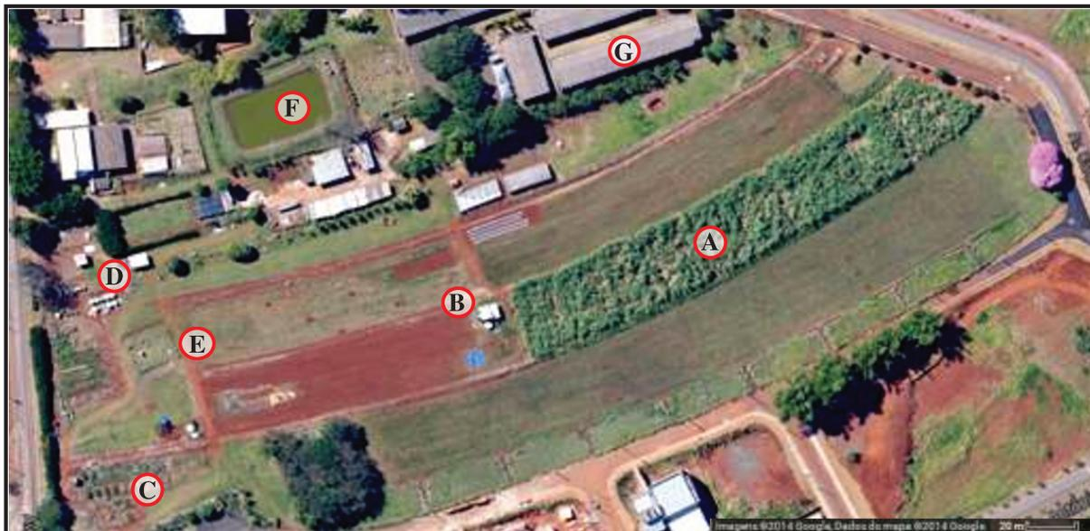
**Figura 23** - Vista aérea da área experimental localizada na FEAGRI/UNICAMP. (A) Área de plantio com cana-de-açúcar; (B) Casa de controle e filtragem do sistema de irrigação; (C) Reatores anaeróbicos (superior) e tanque de macrófitas do sistema de tratamento do esgoto; (D) Estação Meteorológica Automática da CEPAGRI; (E) Reservatório de água superficial; (F) Laboratório de hidráulica.
