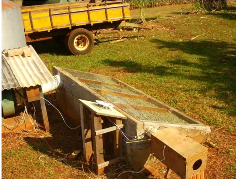
Figura 13: Montagem experimental para o levantamento da curva característica do coletor armazenador.
