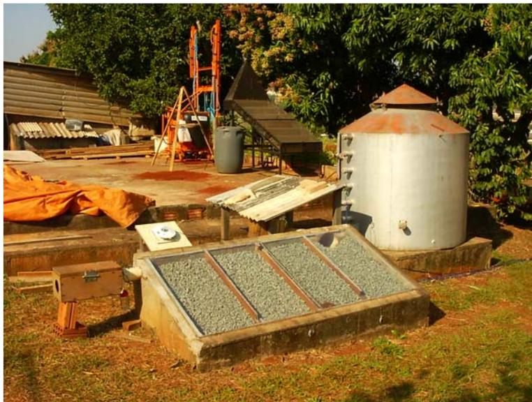
**Figura 20:** Sistema de secagem de grãos com utilização de energia solar.
