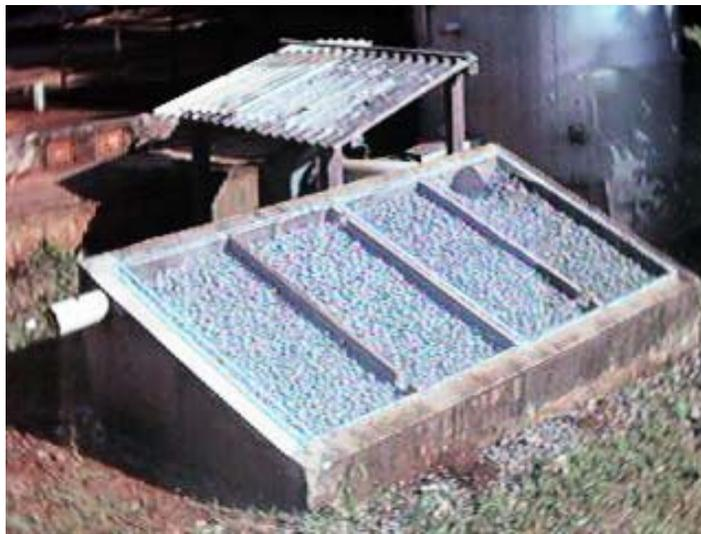
**Figura 11:** Construção do coletor armazenador de energia.
