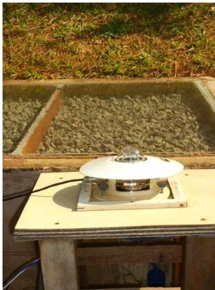
Figura 12: Piranômetro Eppley no plano do coletor armazenador.
