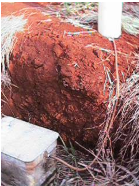
FIGURA 10 – Visão do sistema reservatório – caixa de água em evapotranspirômetro pertencente à parcela subdividida entre as cultivares SP 801842 e SP 791011
