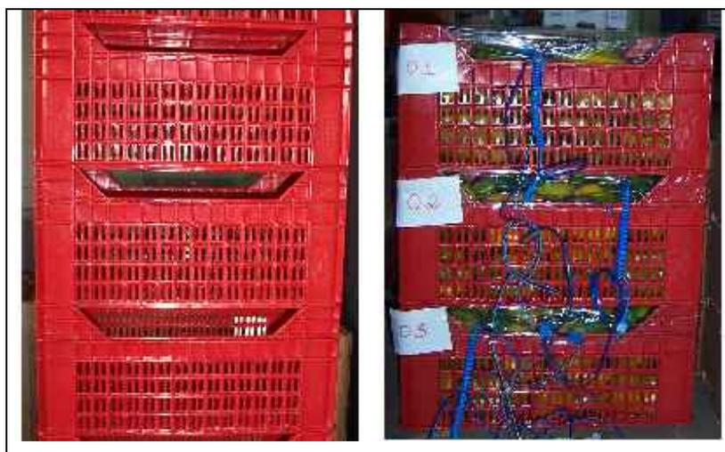
Figura 10 – Detalhe da abertura indesejada das caixas plásticas e a vedação com fita adesiva.
