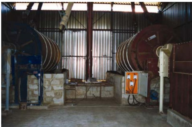
Figura 4.8- Instalação para secagem e disposição dos secadores.
