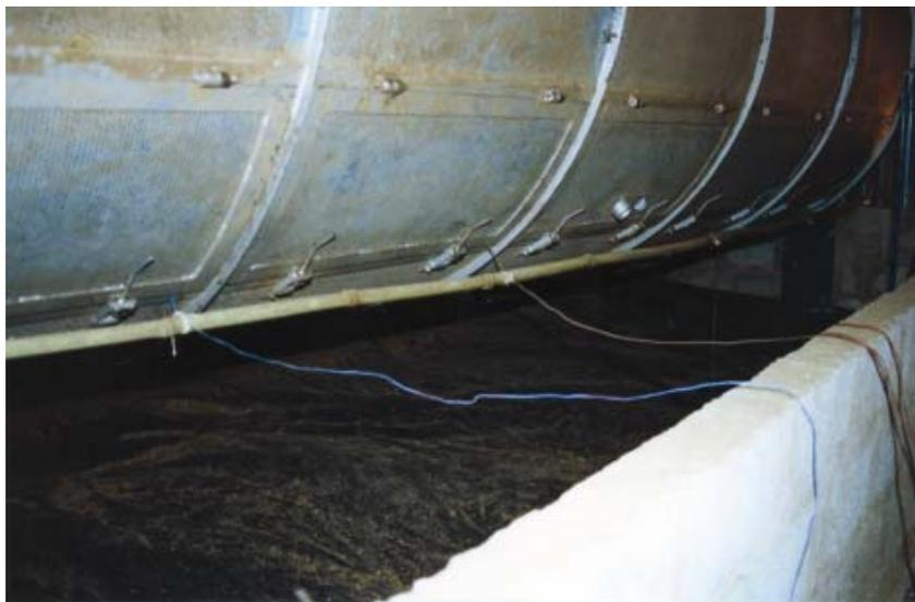
Figura 4.16- Posição dos termopares no cilindro de secagem.
