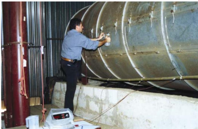
Figura 4.21- Retirada de amostra do secador.
