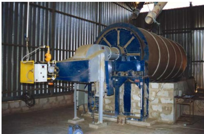
Figura 4.9- Secador com Queimador Noway EC-5 em operação.
