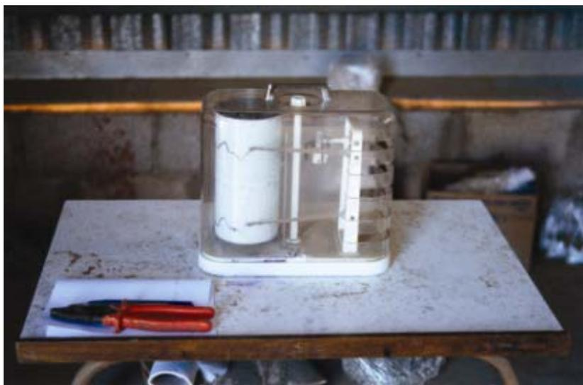
Figura 4.13-Termohigrógrafo para o registro das condições ambientais.
