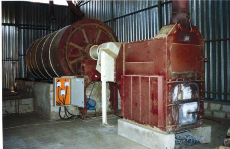
Figura 4.10- Secador com Fornalha FTC-04 em operação
