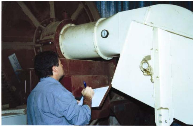
Figura 4.14- Registro de temperatura do ar de secagem.
