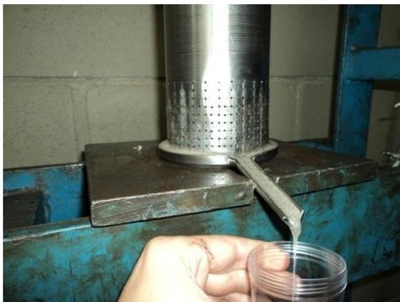
Figura 14. Extração do óleo efetuado pela prensagem dos grãos em cilindro perfurado.
