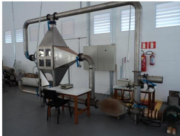
Figura 9. Secador Convectivo conjugado de fluxo perpendicular e/ou paralelo ao leito de secagem utilizado nos tratamentos de secagem.
