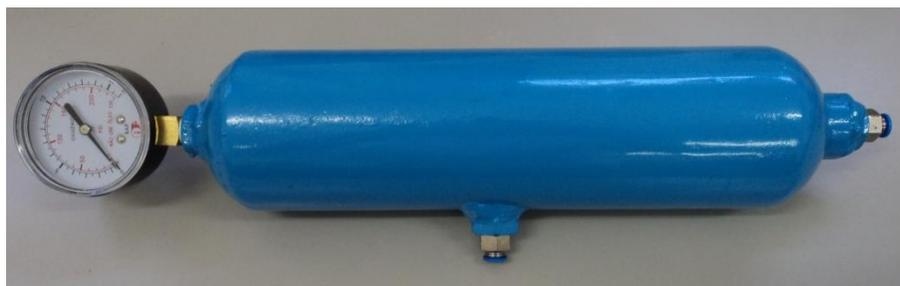
Figura 27. Reservatório de ar comprimido.
