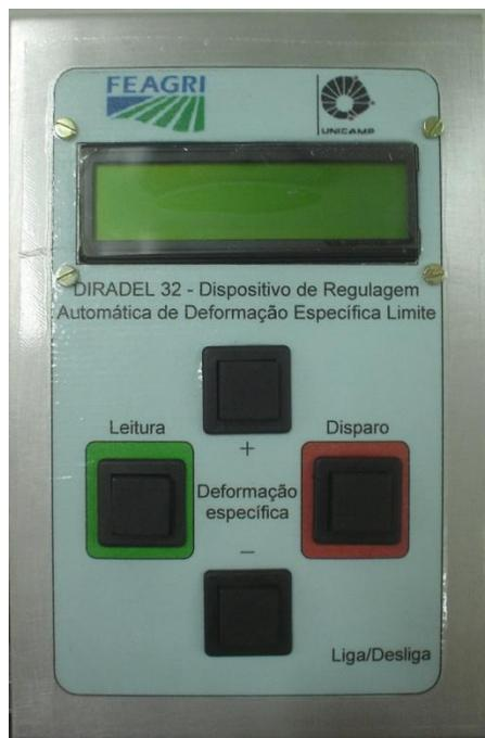
Figura 28. Caixa metálica contendo os componentes eletrônicos.
