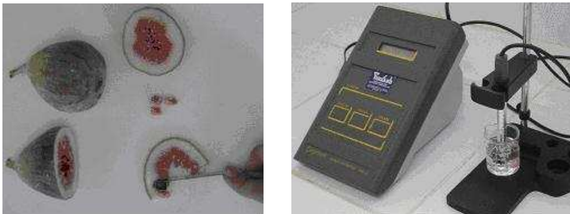
Figura 8. Extração de espécimes do figo (esquerda) e condutivímetro utilizado para medida de condutividade elétrica (direita).
