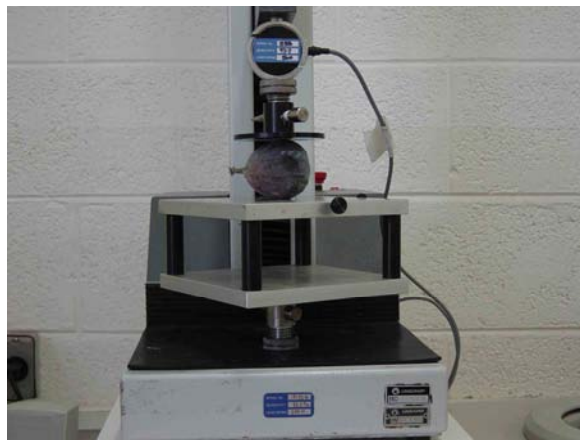
Figura 7. Aspecto da compressão diametral de figo entre pratos planos e paralelos.
