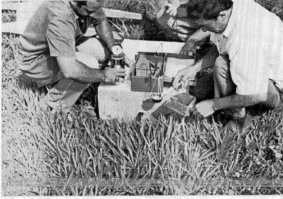
Figura 8. Controle da umidade através do "Speed-test"
