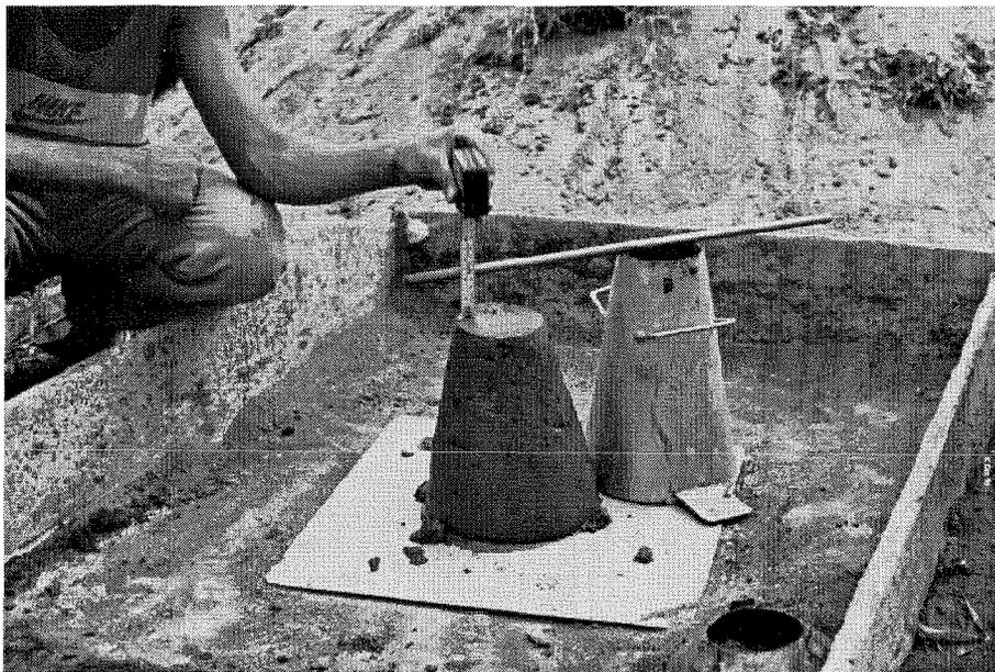
Figura 11. Controle da umidade através do "Slump-Test"
