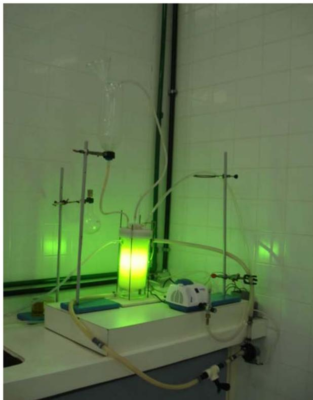
**Figura 4** - Foto do reator fotocatalítico em funcionamento.
