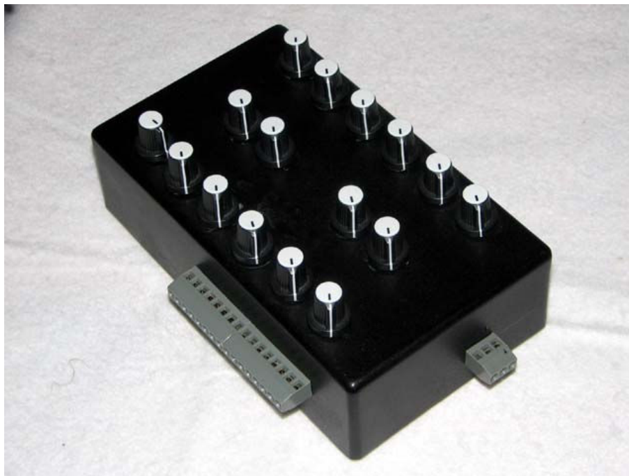
Figura 4: Bancada para geração de sinais analógicos
