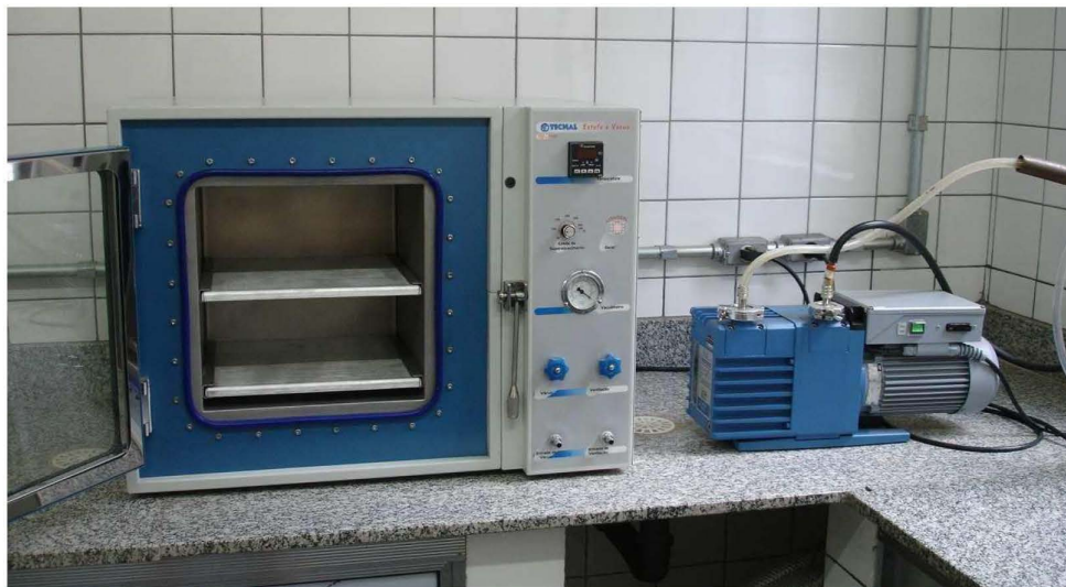
Figura 3. Estufa a vácuo, para determinação da umidade de frutas e hortaliças. (Laboratório de Engenharia de Sistemas Agroalimentares, Faculdade de Engenharia de Alimentos/UNICAMP).
