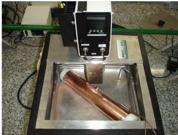
Figura 6. Banho termostático com cápsula metálica. (Laboratório de Engenharia de Sistemas Agroalimentares – Faculdade de Engenharia de Alimentos/UNICAMP).
