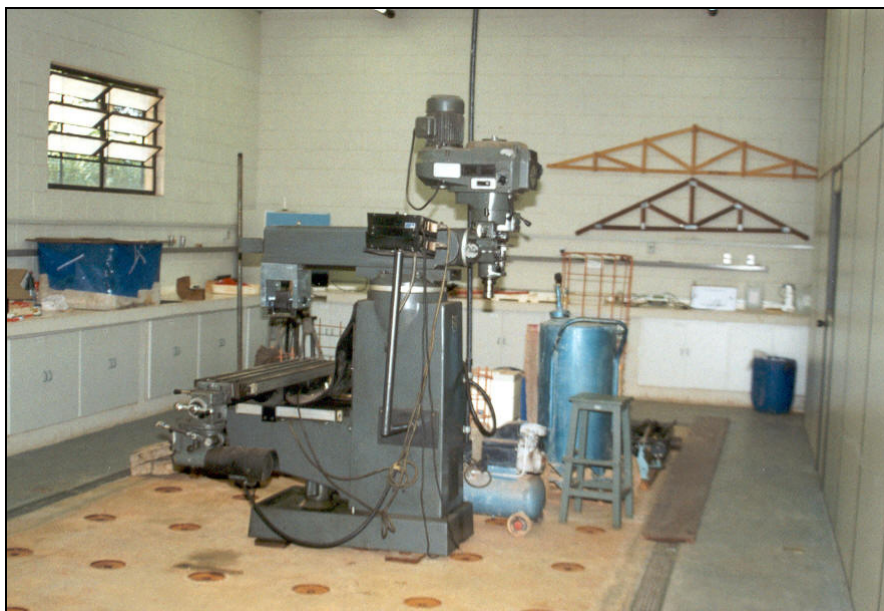
Figura 4.3. Fresadora Infresa instalada no Laboratório de Ensaio de Materiais e Estruturas (LEME).
