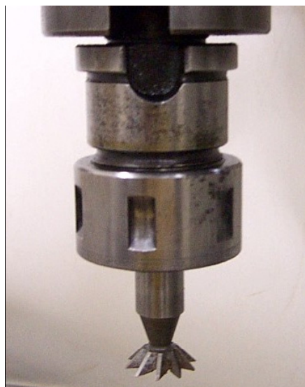
Figura 4.14. Fresa frontal de perfil utilizada para corrigir a superfície irregular dos corpos-de-prova no corte 90-90
