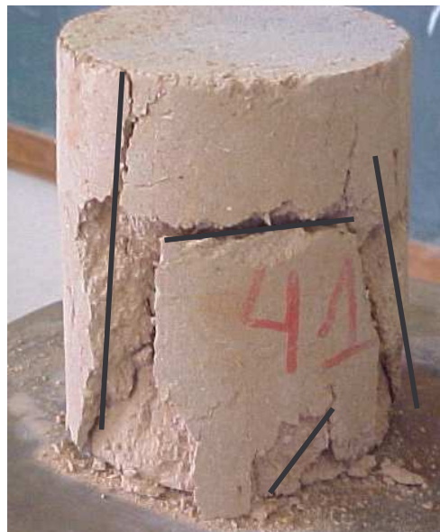
Figura 35. Corpo-de-prova de solo-cimento-casca após ensaio de compressão.
