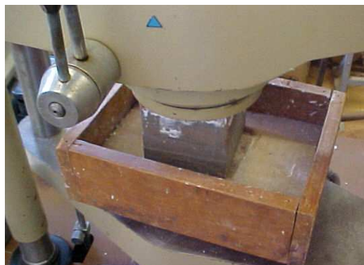
Figura 15. Tijolos sob compressão.
