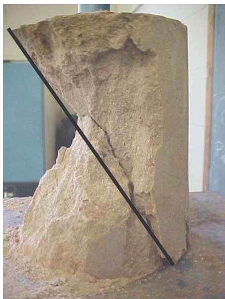
Figura 34. Corpo-de-prova de solo-cimento após ensaio de compressão.
