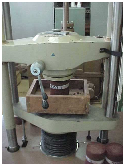
Figura 8. Corpo-de-prova cilíndrico sob compressão simples.
