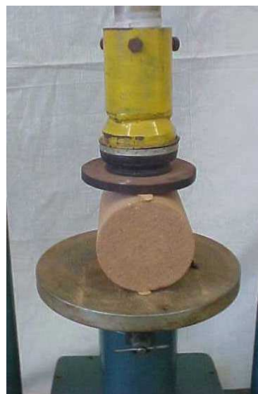
Figura 9. Corpo-de-prova cilíndrico sob compressão diametral.
