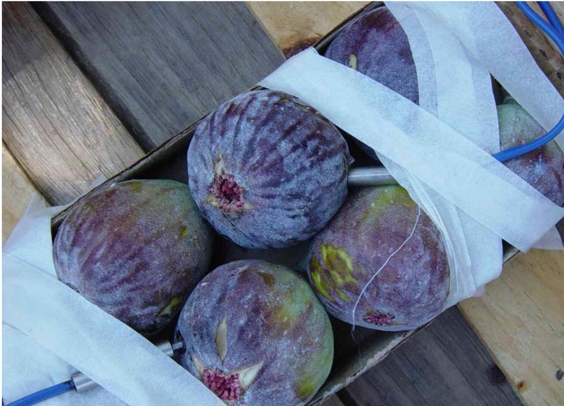
Figura 4.4.4.1 Termopares inseridos nos figos.
