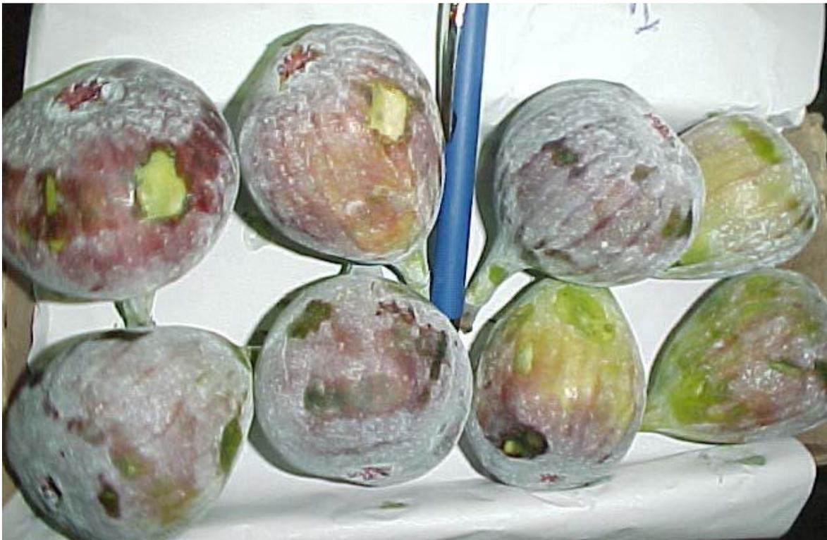
Figura 5.8.1 Aparência dos figos após ensaio onde a bandeja trepidou e os figos rolaram com sinais visíveis da remoção da epiderme e perfurações provocadas pelos pedúnculos.
