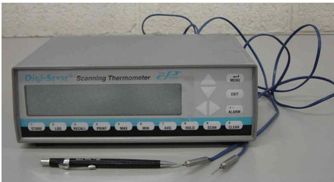
Figura 4.3.5.1. Registrador de temperatura e termopares.
