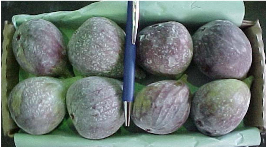
Figura 5.8.3 Aparência dos figos após ensaio, a bandeja sem danos de vibração.
