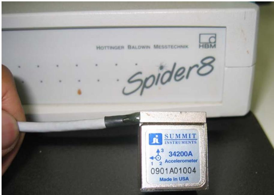
Figura 4.3.4.1. Acelerômetro triaxial e vista frontal do Spider 8.
