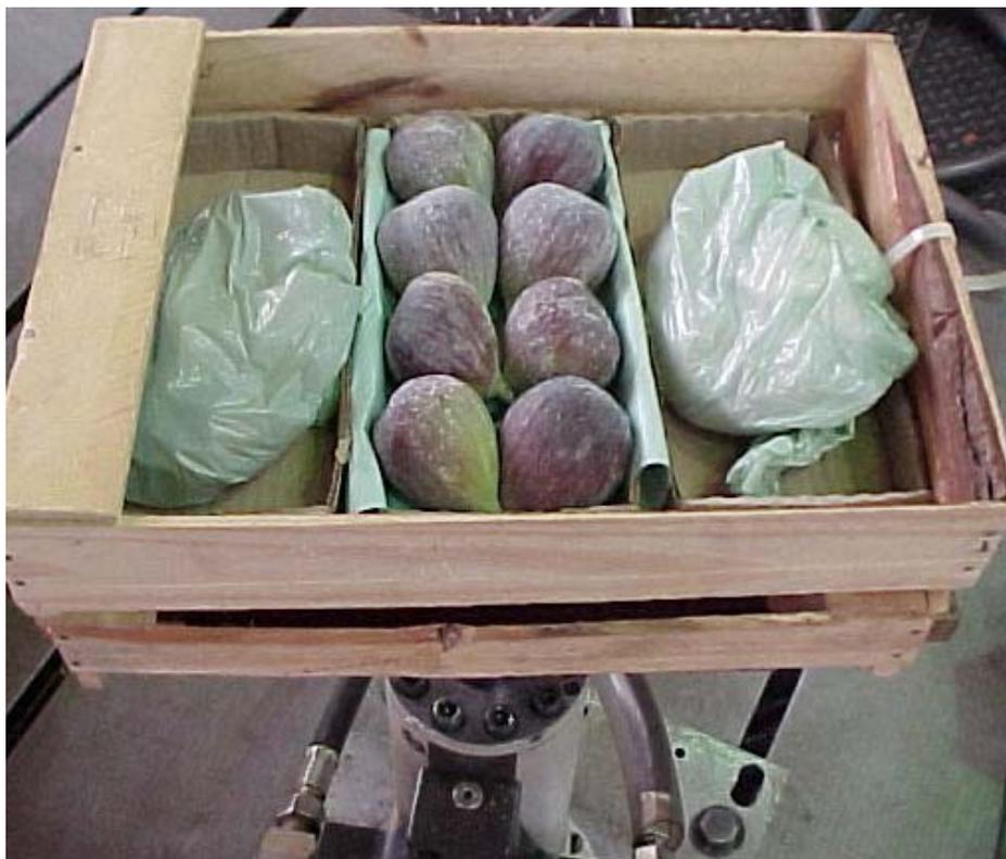
Figura 4.4.5.1 Detalhe da montagem dos engradados no sobre o atuador hidráulico.
