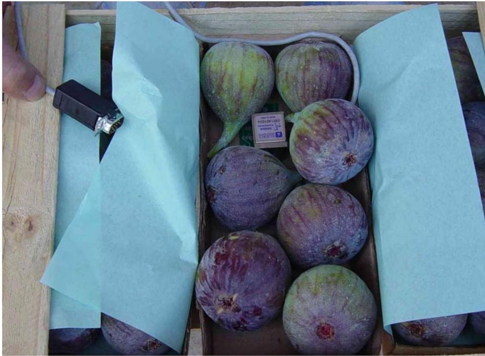
Figura 4.4.2.1 Engradado com as bandejas e a posição do acelerômetro na bandeja central.
