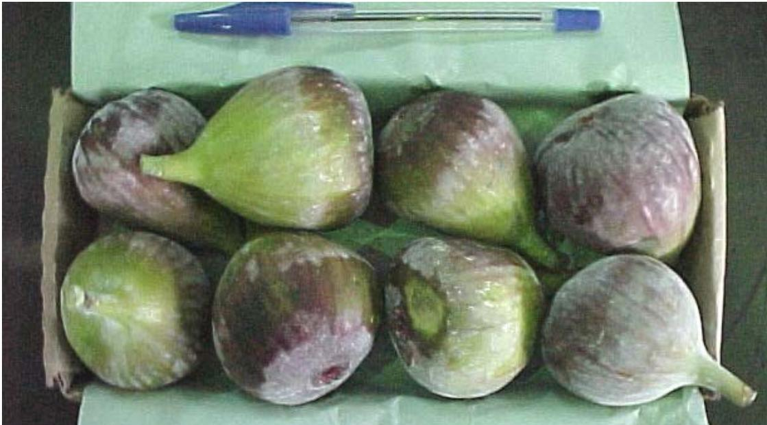
Figura 5.8.2 Aparência dos figos após ensaio de vibração, com sinais de danos.
