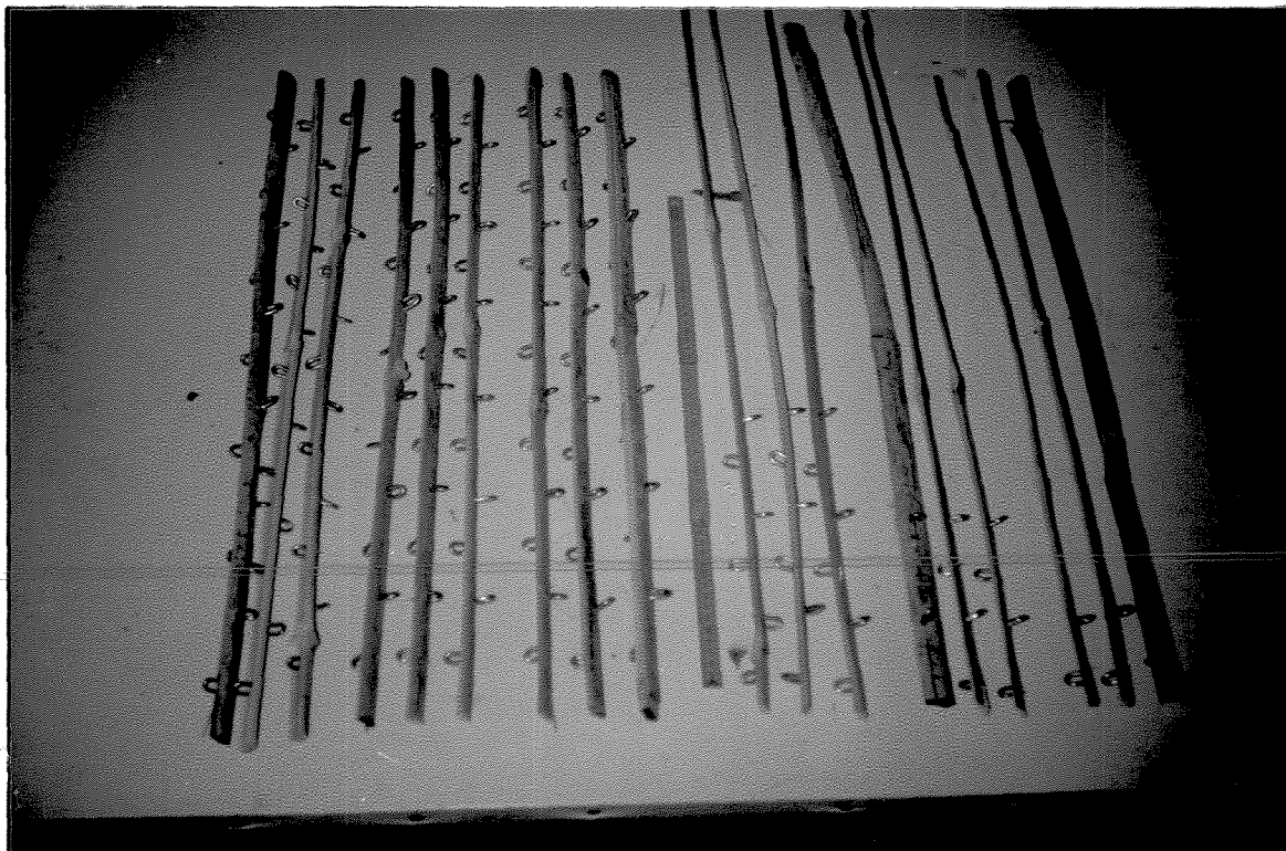
FIGURA 9.- Tratamento "Grampos de Cerca" (GC), aplicado sobre as taliscas de bambu utilizadas nos testes de arrancamento e de flexão simples.
