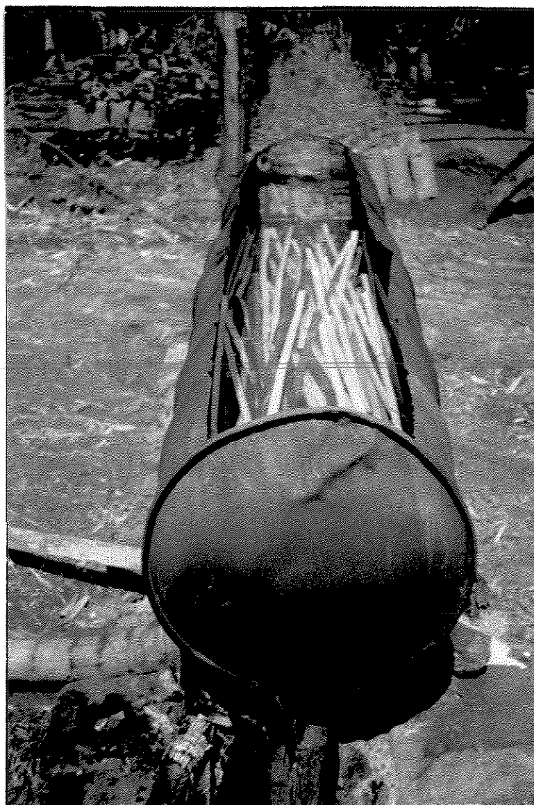
FIGURA 4. - Recipiente usado para a fervura da água no pré-tratamento das taliscas de bambu
