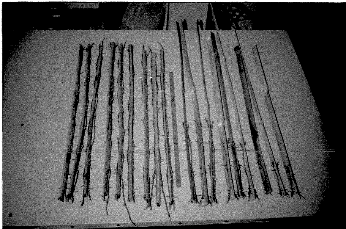
FIGURA 10.- Tratamento "Arame Farpado" (AF), aplicado sobre as taliscas de bambu utilizadas nos testes de arrancamento e de flexão simples.
