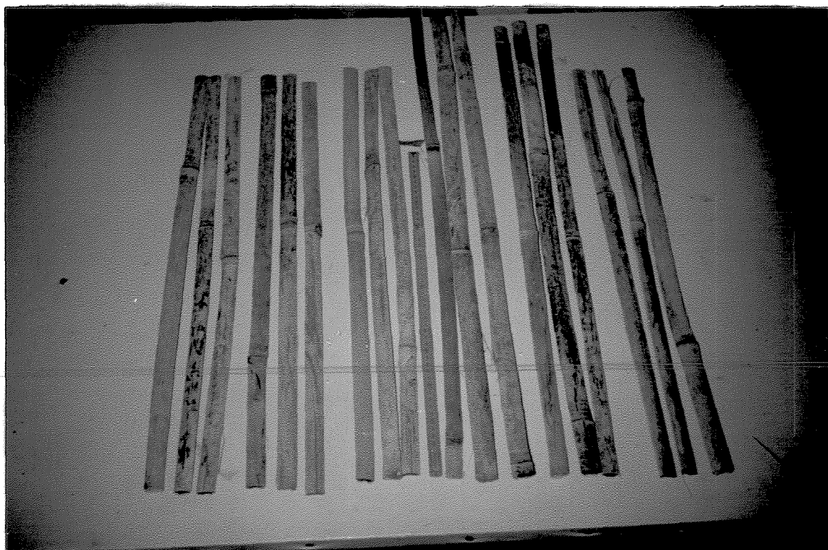
FIGURA 7.- Tratamento "Testemunha" (TT), aplicado sobre as taliscas de bambu utilizadas nos testes de arrancamento e de flexão simples.
