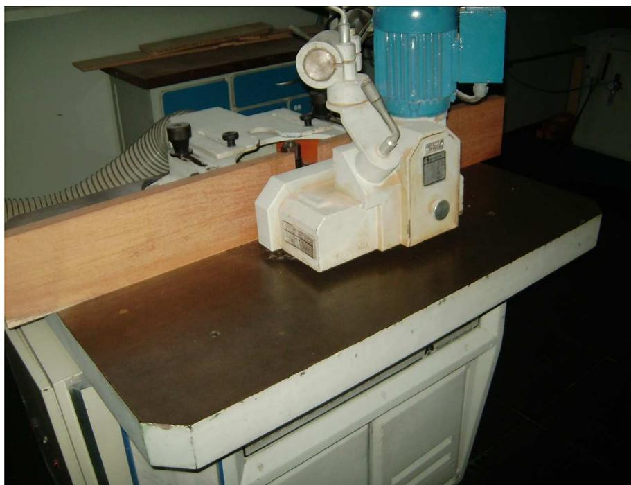
**Figura 46** - Máquina operatriz fresadora lateral (tupia), localizada nas instalações da Escola SENAI Luiz Scavone e utilizada para a realização dos ensaios.
