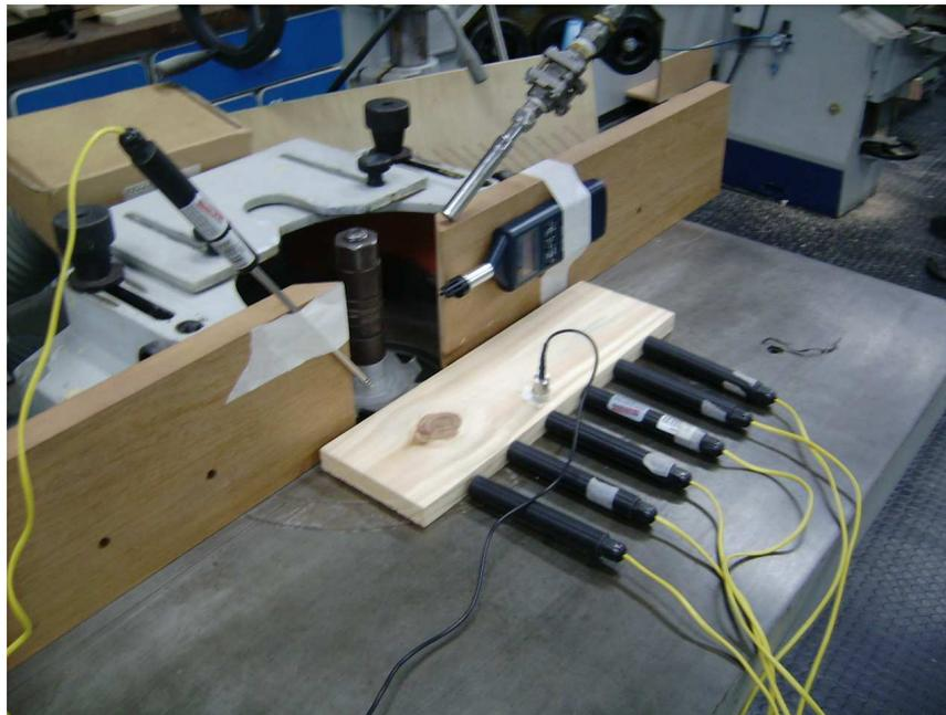
**Figura 50 -** Sistemas montados – detalhe dos termopares.
