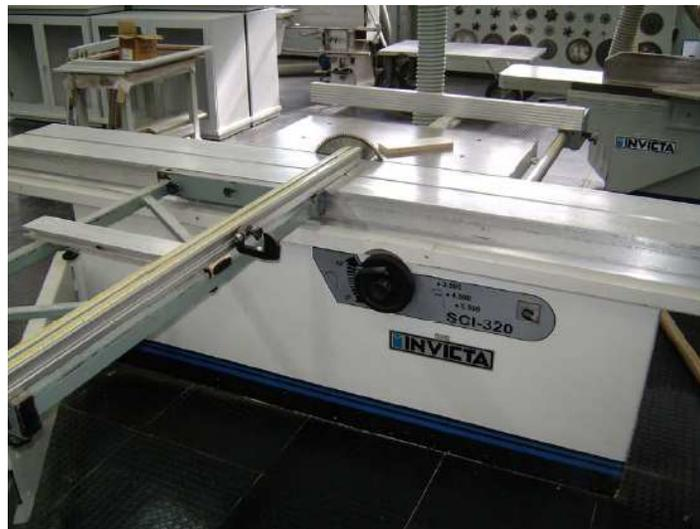
**Figura 20** - Máquina operatriz serra esquadrejadeira localizada nas instalações da Escola SENAI Luiz Scavone e utilizada para a realização dos ensaios.
