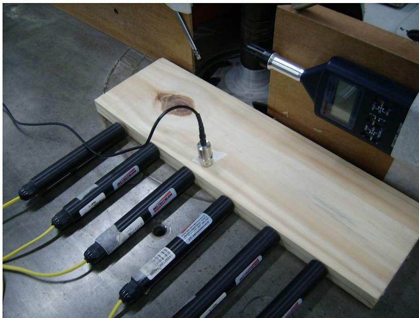
**Figura 52** - Detalhe termo-higrômetro e sensor de vibração.
