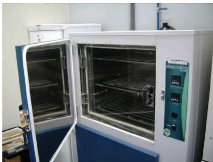
**Figura 18** - Câmara climática utilizada para ajuste de umidade dos corpos de prova.
