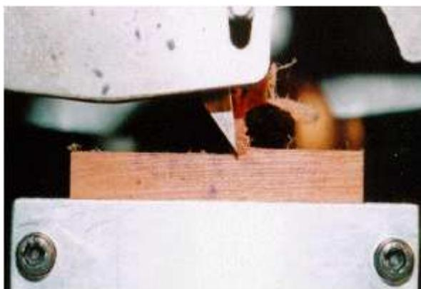
**Figura 9** - Cavaco tipo III obtido no ensaio de serramento circular 90-0. Espécie: Eucalipto Grandis, espessura de corte: 1,52 mm e ângulo de saída:  $\gamma = 10^\circ$ . (NÉRI, 1998).
