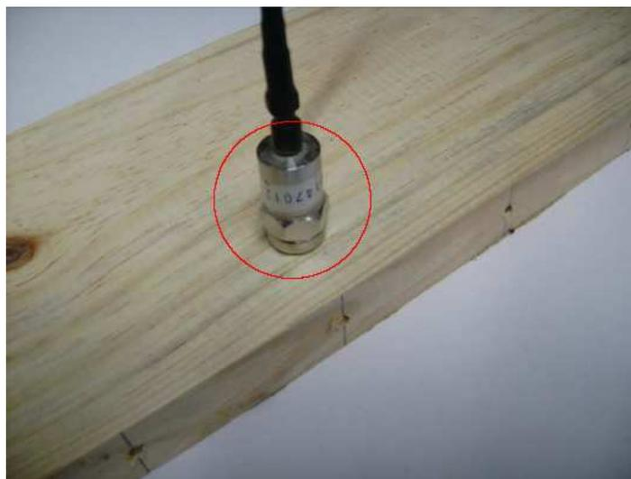
**Figura 35** - Detalhe do posicionamento do sensor de vibração sobre o corpo de prova.
