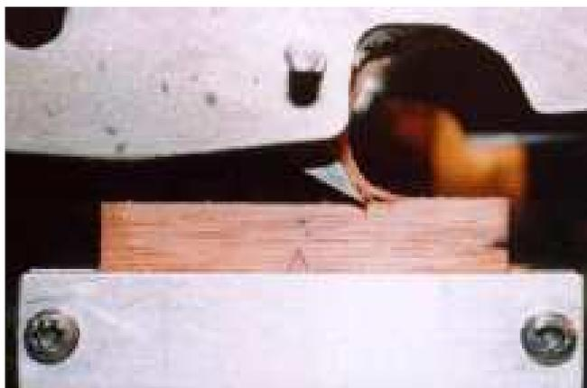
**Figura 7** - Cavaco tipo I obtido no ensaio de serramento circular 90-0. Espécie: Eucalipto grandis, espessura de corte: 1,52 mm e ângulo de saída:  $\gamma = 30^\circ$ . (NÉRI, 1998).
