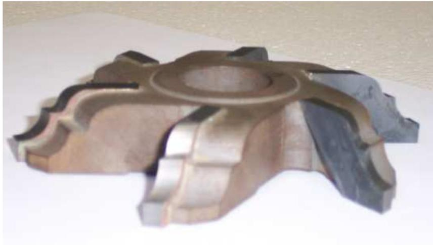
**Figura 14** - Ferramenta de corte utilizada **na qual não** se nota a formação da película de material residual processado.
