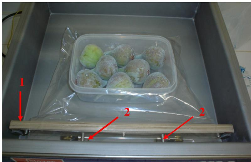
Figura 3. Produto colocado na câmara interna da seladora para iniciar as operações de vácuo parcial, injeção de gases e fechamento das embalagens; (1) barra de selagem. (2) orifícios para injeção de gás.
