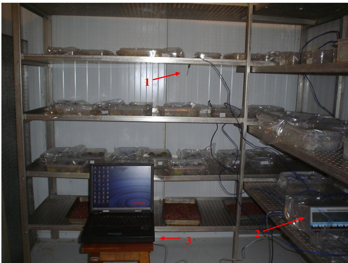
Figura 6. Montagem dos experimentos na câmara fria, mostrando a disposição das embalagens e sistema de aquisição de dados de temperatura. (1) Termopar para medição da temperatura do ar da câmara; (2) Sistema de aquisição de dados de temperatura conectado ao computador (3).
