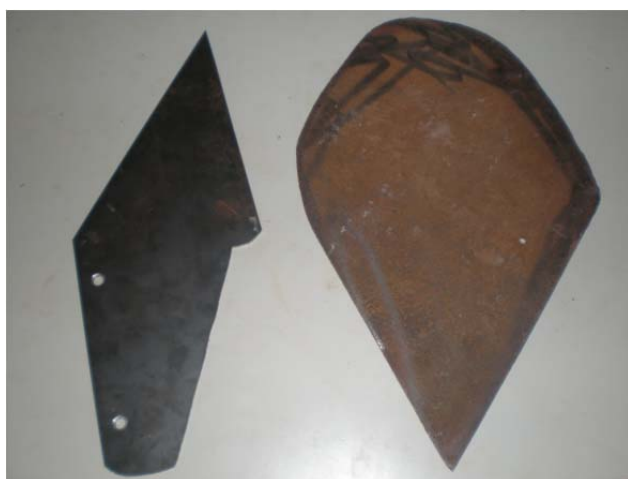
Figura 22 – Gabaritos em chapa para sulcador e extensão do sulcador
