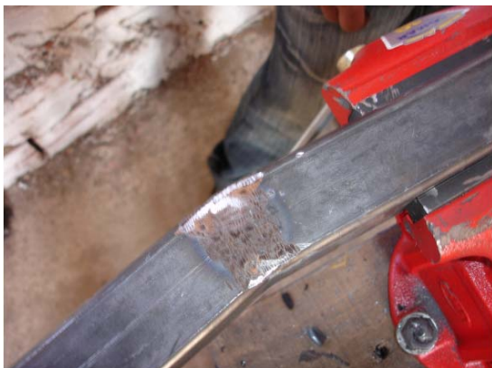
Figura 136 – Acabamento dado no perfil quadrado da barra porta-ferramentas
