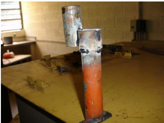
Figura 37 – Gabarito “3” - para a montagem da estrutura de encaixe
