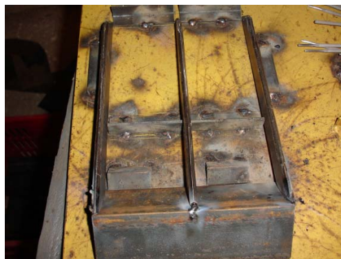
Figura 113 – Grade de dentes montada sobre o gabarito “2”
