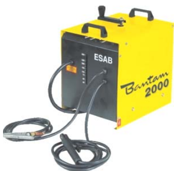
Figura 30– Transformador de solda
