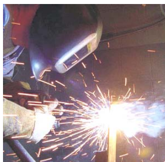
Figura 31 – Soldador utilizando o processo de solda com eletrodo consumível revestido
