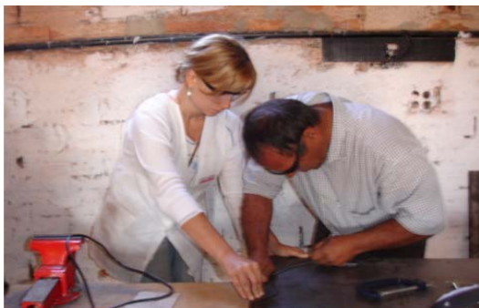
Figura 67 – Treinamento para marcação com riscador e gabarito para corte em chapa com serra tico-tico
