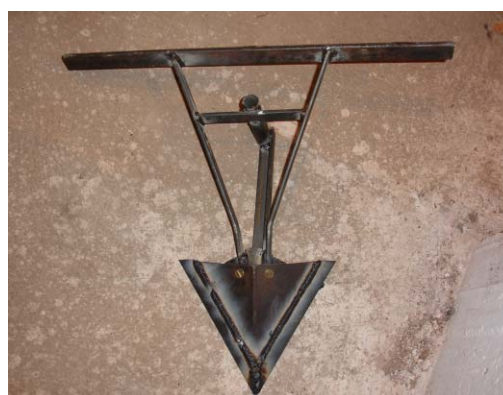
Figura 121 – Cultivador ajustável montado completamente.
