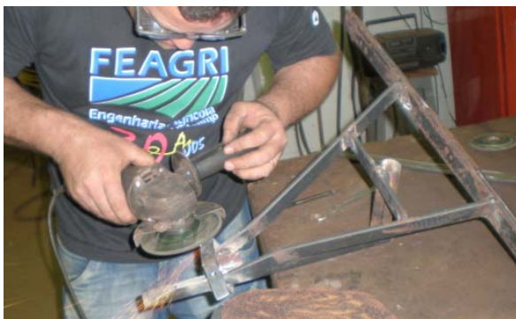
Figura 41 – Acabamento da estrutura principal do cultivador ajustável
