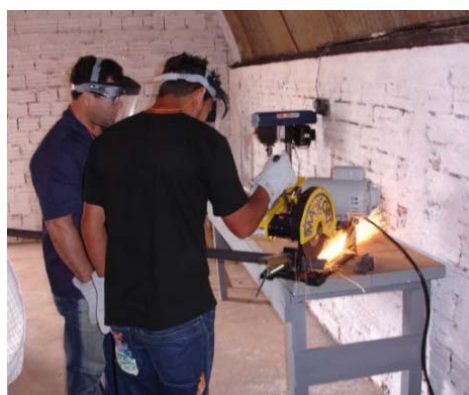
Figura 53 – Procedimento de corte com policorte – participante O.J.O.
