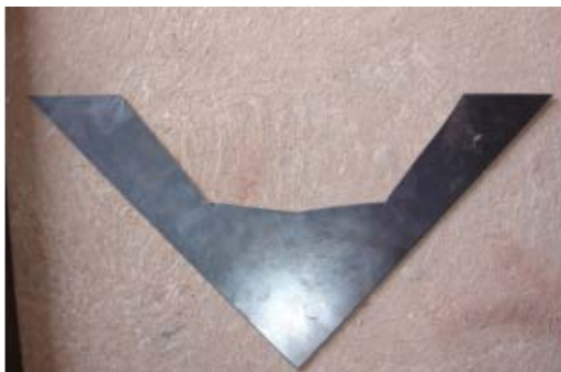
Figura 70 – Chapa do cultivador simples (de maior tamanho) cortada com a serra tico-tico
