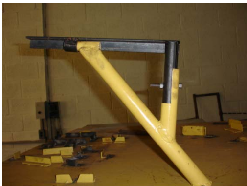
Figura 32 – Estrutura padrão montada sobre o gabarito
