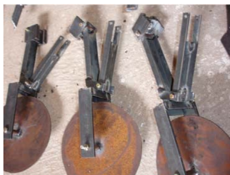
Figura 127 – Rodas guia montadas por completo
