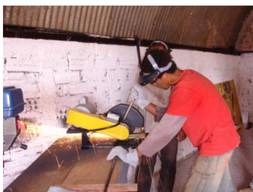
Figura 55 – Procedimento de corte com policorte – participante I.F.
