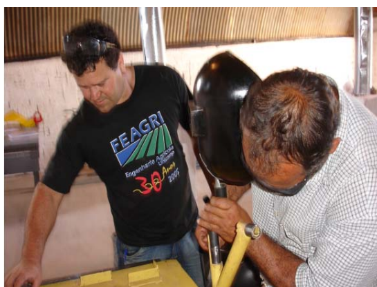
Figura 105 – Participante montando as peças da estrutura padrão sobre o gabarito
