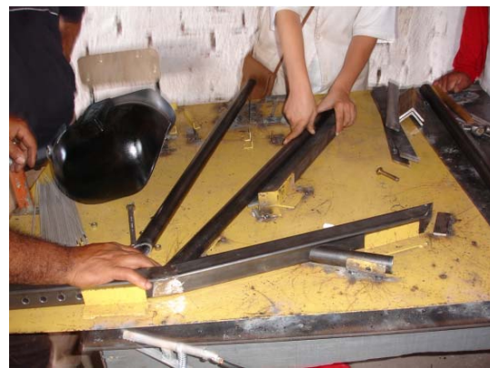
Figura 117 – Ministrante do curso mostrando, aos participantes, o encaixe das peças chassi das barra porta ferramentas no gabarito de montagem “2”
