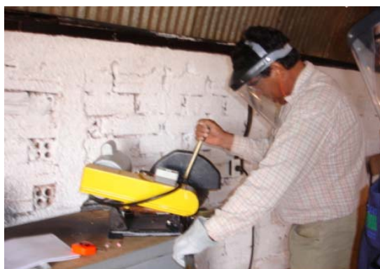
Figura 54 – Procedimento de corte com policorte – participante J.A.D.
