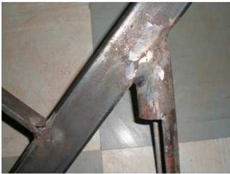
Figura 42 – Acabamento da barra porta-ferramentas
