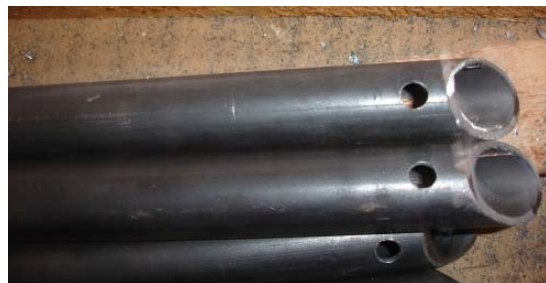
Figura 79 – Tubos do cultivador de encaixe já perfurados
