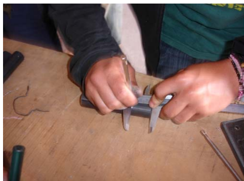
Figura 74 – Participante realizando o procedimento de marcação da peça com riscador e paquímetro
