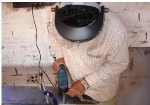
Figura 68 – Procedimento de corte em chapa com serra tico-tico - participante J.A.D.
