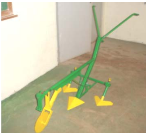
Figura 2 – Barra porta-ferramentas acoplada ao cultivador ajustável
