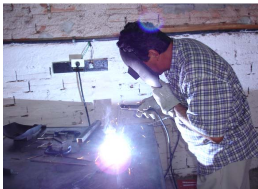
Figura 101 – Procedimento de solda em algumas peças do multi-implemento – participante J.A.D.
