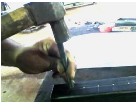
Figura 17 – Procedimento de marcação com martelo e punção
