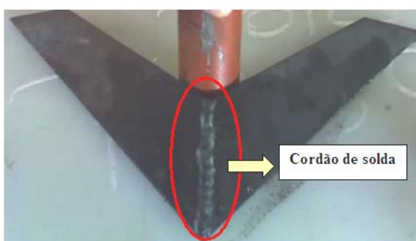
Figura 33 – Solda contínua do tipo cordão
