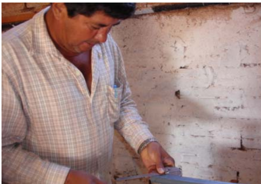
Figura 59 – Procedimento de marcação de uma peça para corte angular - participante J.A.D.
