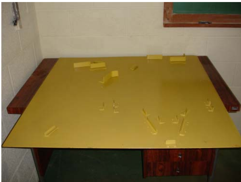
Figura 33 – Gabarito “2” - para montagem da barra porta-ferramentas, cultivador ajustável e grade de dentes
