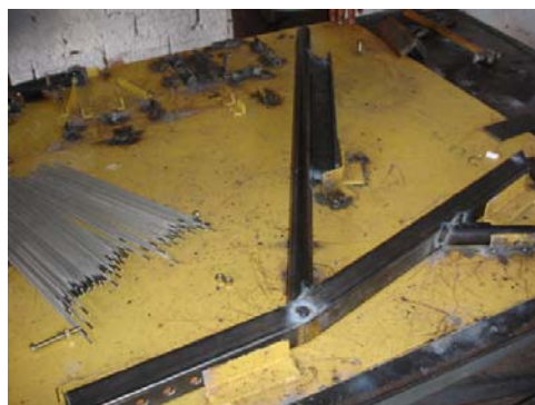
Figura 119 – Chassi montado e soldado com o auxílio do gabarito “2”
