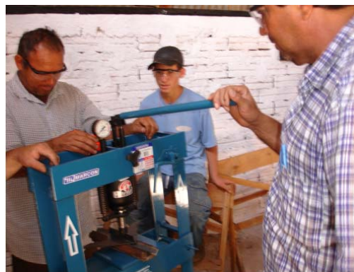
Figura 92 – Agricultores realizando procedimento de dobra com prensa hidráulica
