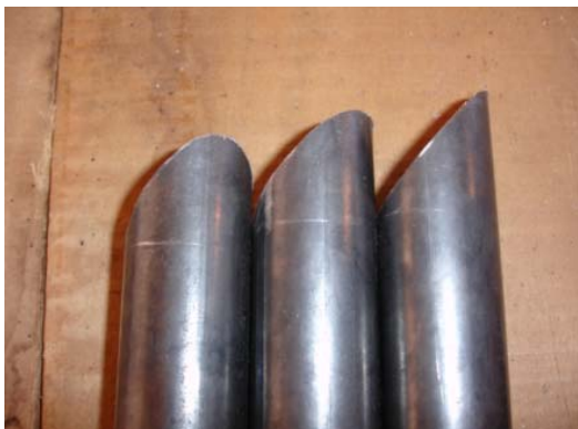
Figura 65 – Tubos cortados com serra manual
