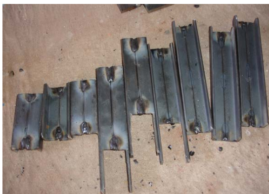
Figura 102 – Pares de cantoneiras das rodas guia soldados
