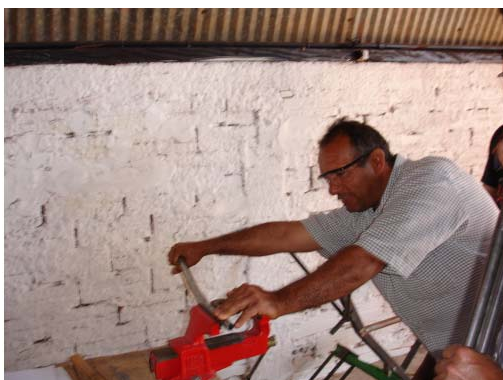
Figura 89 – Procedimento de dobra com torno – participante H.R.P.
