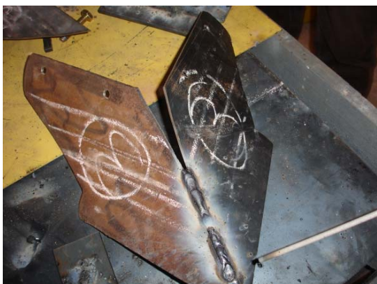
Figura 124 – Chapas do sulcador soldadas
