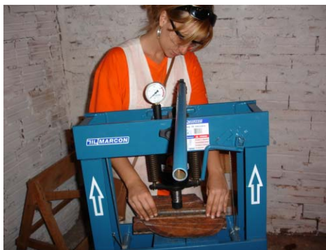
Figura 91 – Ministrante do curso demonstrando aos agricultores o procedimento de dobra com a prensa hidráulica, utilizando-se os gabaritos
