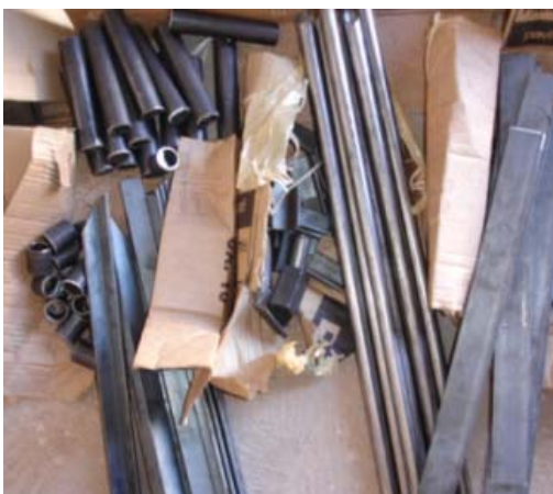
Figura 56 – Materiais cortados com a serra policorte
