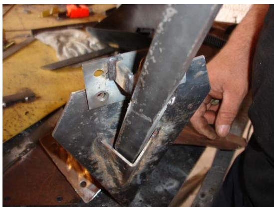
Figura 128 – Montagem do arado de aiveca sobre o gabarito “5”
