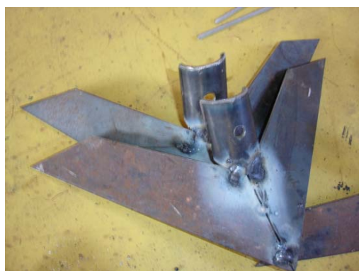
Figura 109 - enxadas do cultivador de encaixe já montadas
