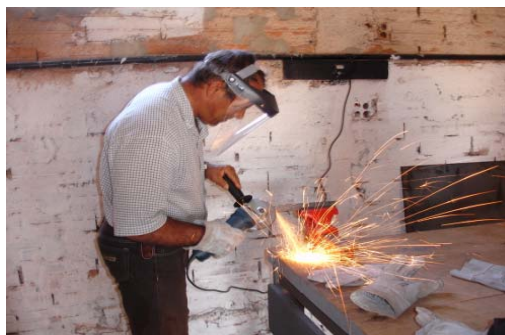
Figura 83 – Procedimento de retirada das rebarbas com a esmerilhadeira angular – participante H.R.P.
