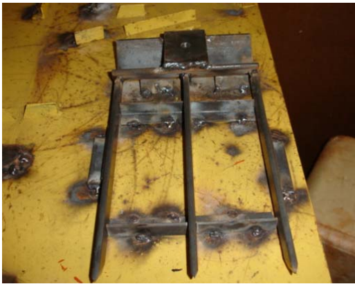
Figura 36 – Montagem da grade de dentes sobre o gabarito
