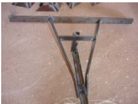
Figura 118 – Cultivador ajustável parcialmente montado
