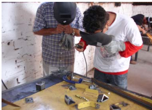
Figura 111 – Solda das peças do cultivador de encaixe – participante O.J.O.
