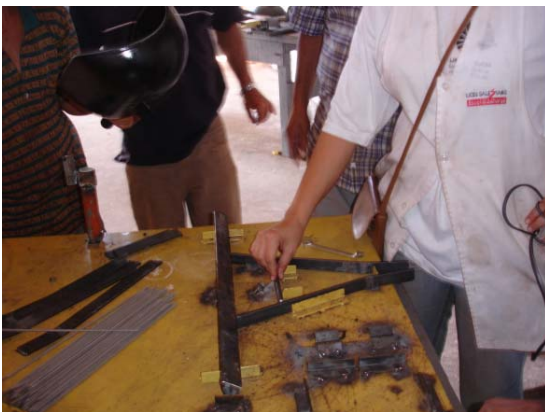
Figura 116 – Ministrante do curso mostrando, aos participantes, o encaixe das peças do cultivador ajustável no gabarito de montagem “2”
