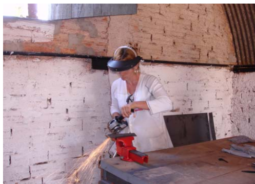
Figura 81 – Ministrante do curso mostrando aos agricultores o procedimento de retirada das rebarbas com a esmerilhadeira angular
