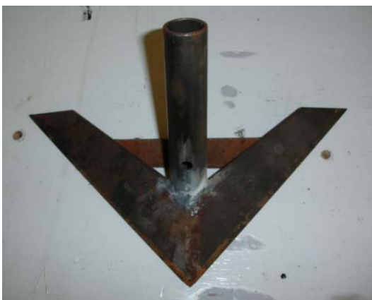
Figura 38 – Gabarito “4” – para a montagem da enxada do cultivador de encaixe
