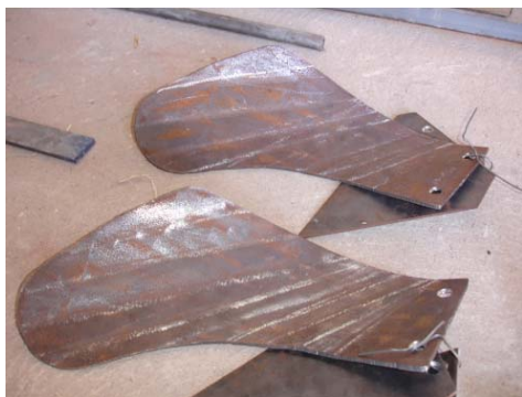
Figura 95 – Aivecas dobradas com a prensa hidráulica
