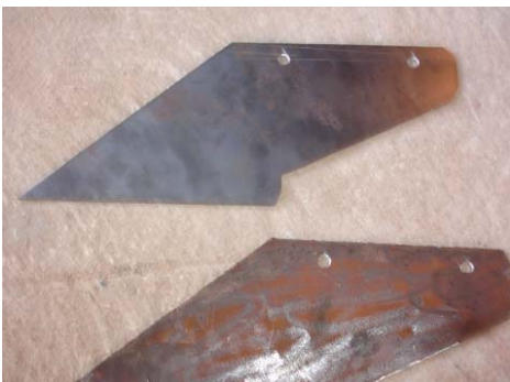
Figura 78 – Chapas do sulcador já perfuradas
