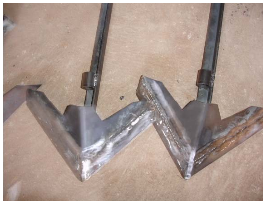
Figura 137 – Enxadas dos cultivadores simples (menor tamanho) depois de afiadas com a esmerilhadeira angular.
