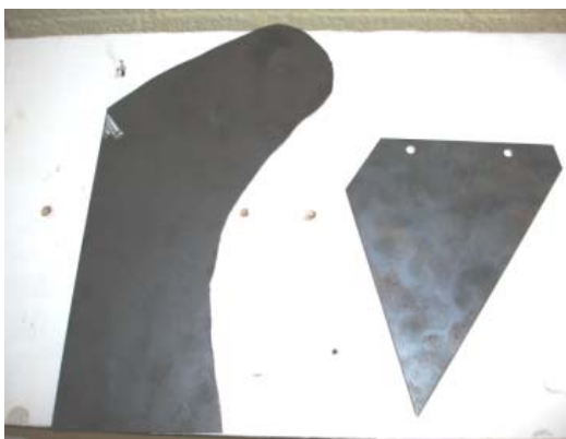
Figura 13 – Moldes em chapa (arado -aiveca e relha)
