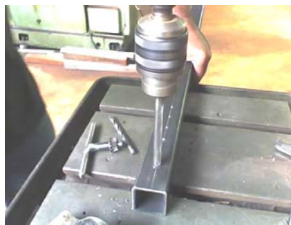
Figura 18 – Perfuração do perfil quadrado
