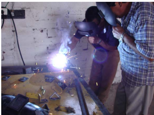
Figura 100 – Procedimento de solda em algumas peças do multi-implemento – participante J.S.
