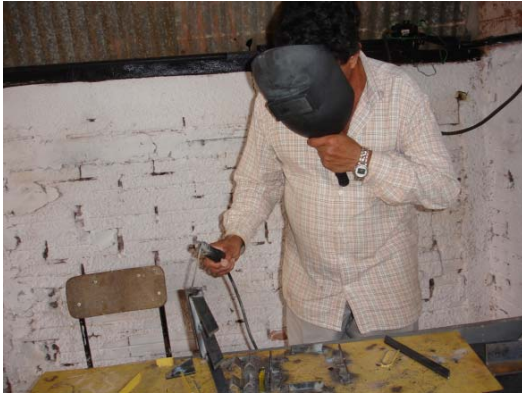
Figura 114 – Participante J.A.D. fazendo o cordão de solda em uma das grades de dentes
