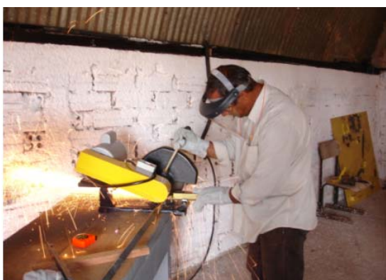
Figura 52 – Procedimento de corte com policorte – participante H.R.P.
