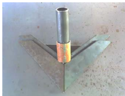
Figura 40 – Enxada do cultivador de encaixe montada sobre o gabarito 4
