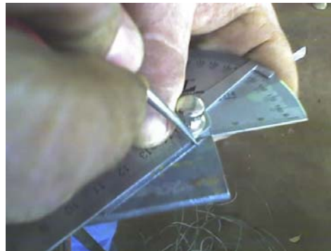
Figura 11 – Marcação com transferidor e o riscador para corte em ângulo
