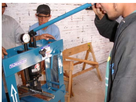
Figura 93 – Procedimento de dobra com prensa hidráulica - participante O.J.O.
