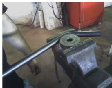
Figura 24 – Dobra com torno de bancada
