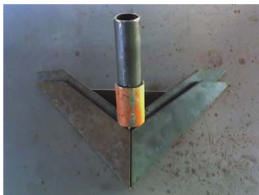
Figura 40 – Peças do cultivador de encaixe montada sobre o gabarito “4”
