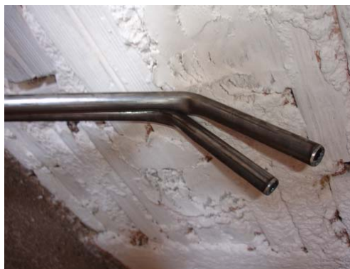
Figura 90 – Tubos de aço carbono dobrados com torno
