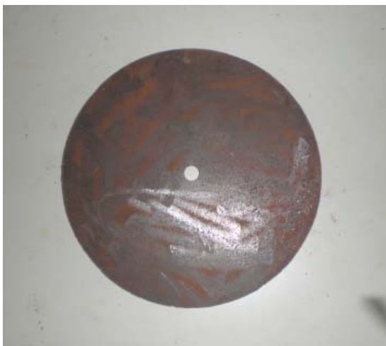
Figura 27 – Gabarito em chapa para o a roda guia
