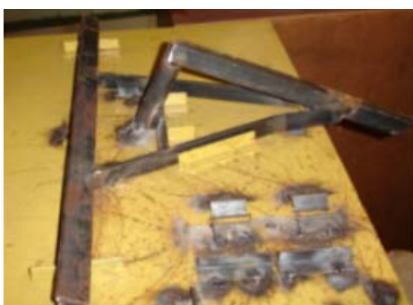
Figura 37 – Montagem do cultivador ajustável sobre o gabarito 2
