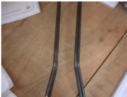
Figura 88 – Peças de barra chata dobradas com torno e marreta
