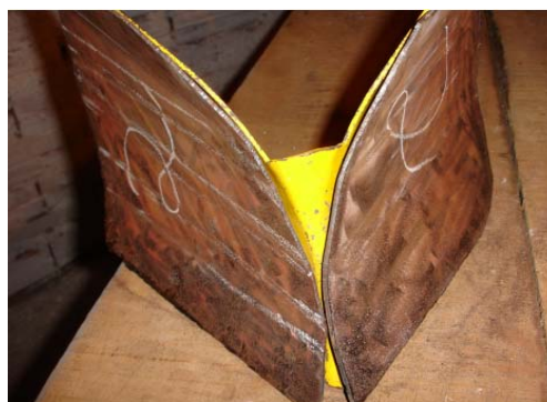
Figura 94 – Chapas do sulcador, já dobradas, colocadas sobre um sulcador já montado
