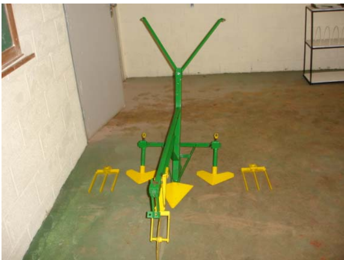
Figura 19 – Vista frontal da barra porta-ferramentas com o cultivador ajustável acoplado
