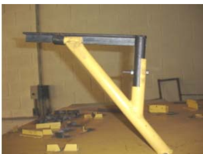
Figura 34 – Montagem da estrutura padrão no gabarito 1
