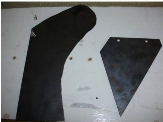
Figura 21 – Gabaritos em chapa para o arado (aiveca e relha)
