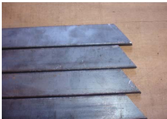
Figura 64 – Barras chatas cortadas com serra manual
