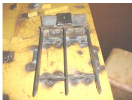
Figura 38 – Montagem da grade de dentes sobre o gabarito 2
