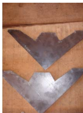
Figura 71 – Chapas dos cultivadores simples (de menor tamanho) cortada com a serra tico-tico
