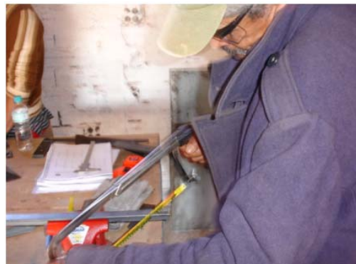
Figura 62 – Procedimento de corte angular com serra manual - participante I.F. 1
