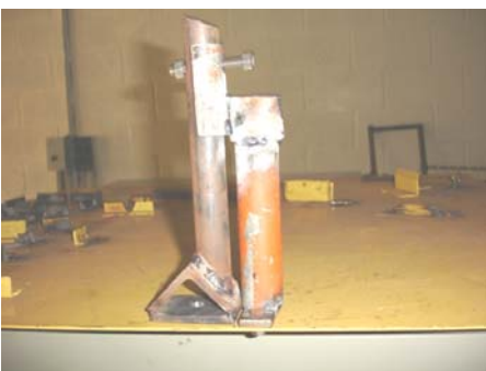
Figura 39 – Estrutura de encaixe do cultivador de encaixe montada no gabarito 3
