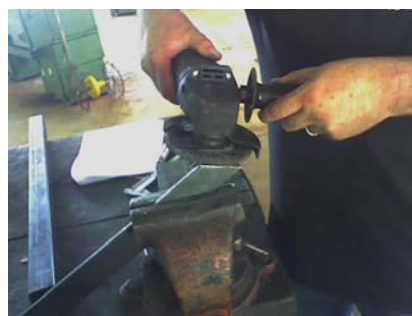
Figura 20 – Esmerilhadeira angular em funcionamento
