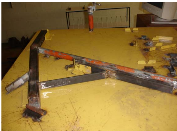
Figura 34 – Montagem do chassi (barra porta-ferramentas) sobre o gabarito
