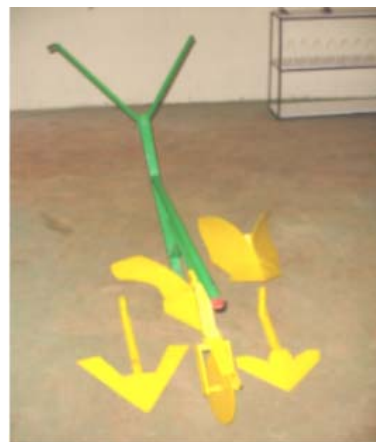
Figura 3 – Outros implementos acoplados a barra porta-ferramentas: arado, cultivadores, sulcador com extensão
