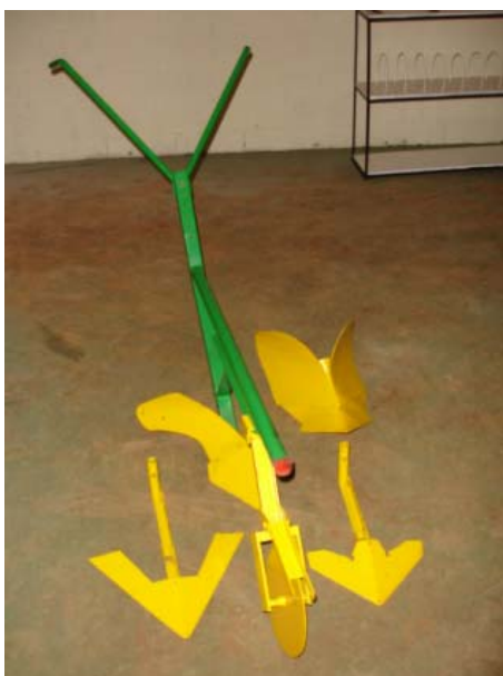
Figura 20 – Outros implementos acoplado a barra porta-ferramentas: arado, cultivadores, sulcador com extensão
