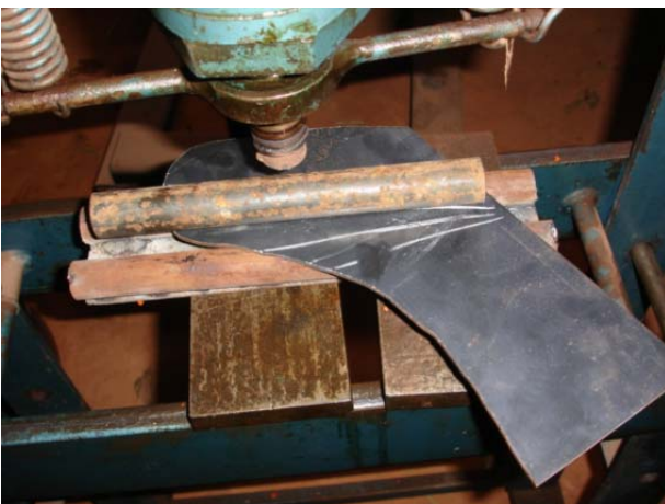
Figura 31– Procedimento de dobra da chapa da aiveca
