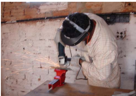
Figura 84 – Procedimento de retirada das rebarbas com a esmerilhadeira angular – participante J.A.D.
