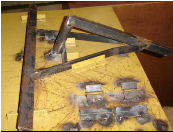
Figura 35 – Montagem do cultivador ajustável sobre o gabarito
