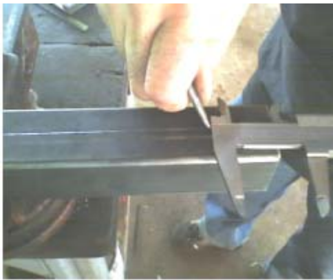
Figura 16 – Marcação da peça com paquímetro e riscador
