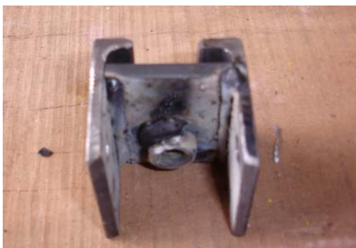
Figura 126 – Estrutura de encaixe (roda guia com chassi) montada
