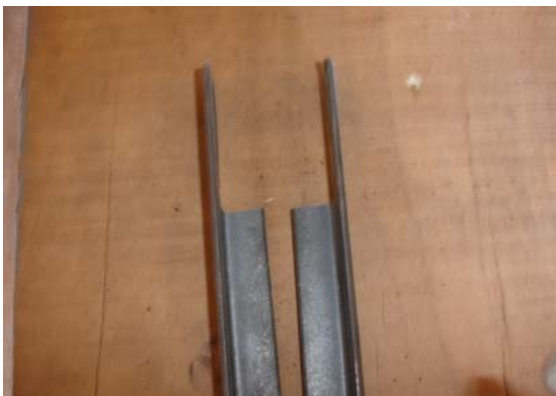
Figura 63 – Cantoneiras cortadas com serra manual
