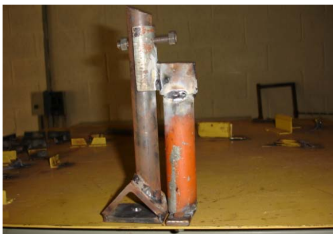
Figura 39 – Peças do cultivador de encaixe montadas no gabarito “3”
