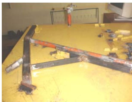
Figura 36 – Montagem do chassi (barra porta-ferramentas) no gabarito 2
