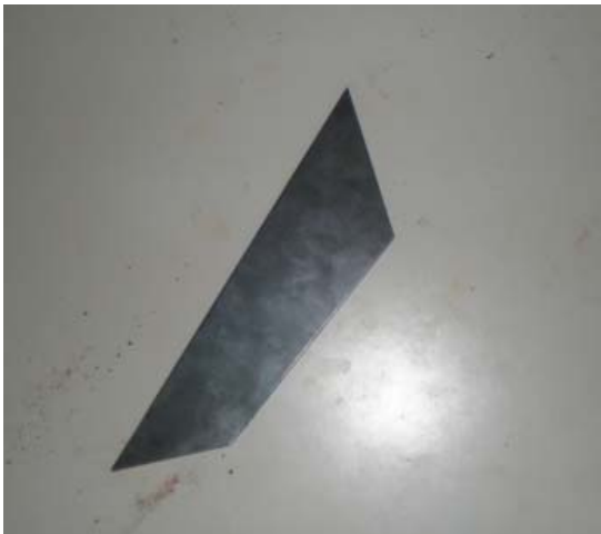
Figura 26 – Gabarito em chapa para o cultivador de encaixe
