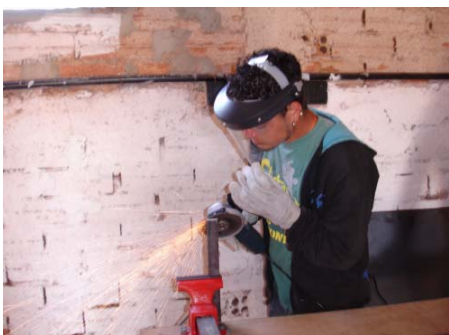
Figura 82 – Procedimento de retirada das rebarbas com a esmerilhadeira angular – participante O.J.O.
