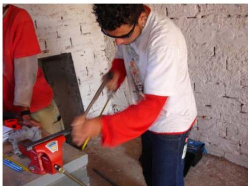
Figura 61 – Procedimento de corte angular com serra manual - participante O.J.O.
