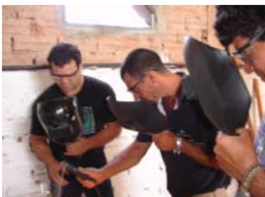
Figura 120 – Finalização da montagem e da solda do cultivador ajustável – participante J.S.
