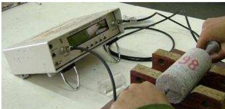
3.17. Aparelho Ultrasonic Tester, com sensor exponencial de 45 kHz.
