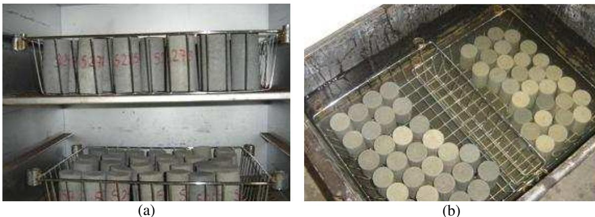
*Figura 3.22. Corpos-de-prova na estufa (a) e corpos-de-prova imersos na água (b).*
