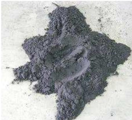
*Figura 3.8. Cinza de casca de arroz residual utilizada nas argamassas.*
