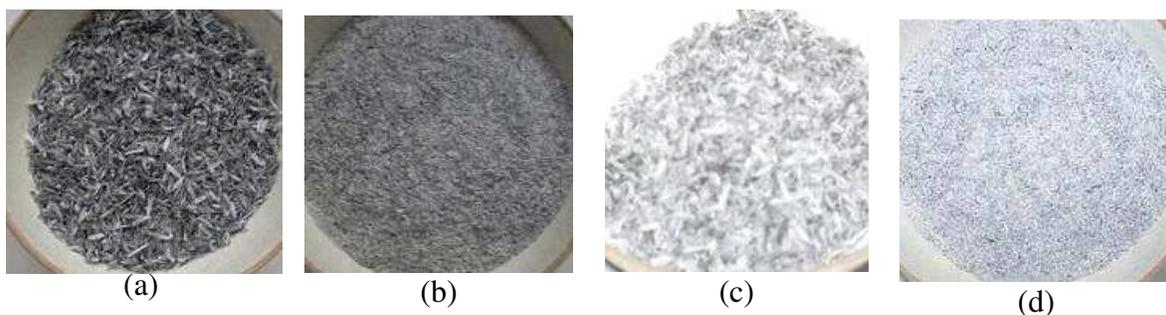
*Figura 3.4. CCAC 06 ao sair da mufla (a) CCAC 06 depois da moagem (b); CCAC 24 ao sair da mufla (c) CCAC 24 depois da moagem (d).*
