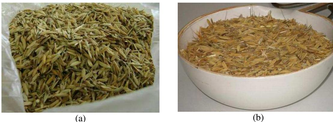
*Figura 3.2. Casca de arroz. (a) recebimento (b) antes de ir à mufla para calcinação.*
