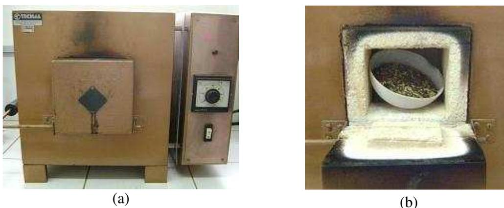
Figura 3.3. Mufla utilizada para queima das cascas de arroz (a) e detalhes internos (b).
