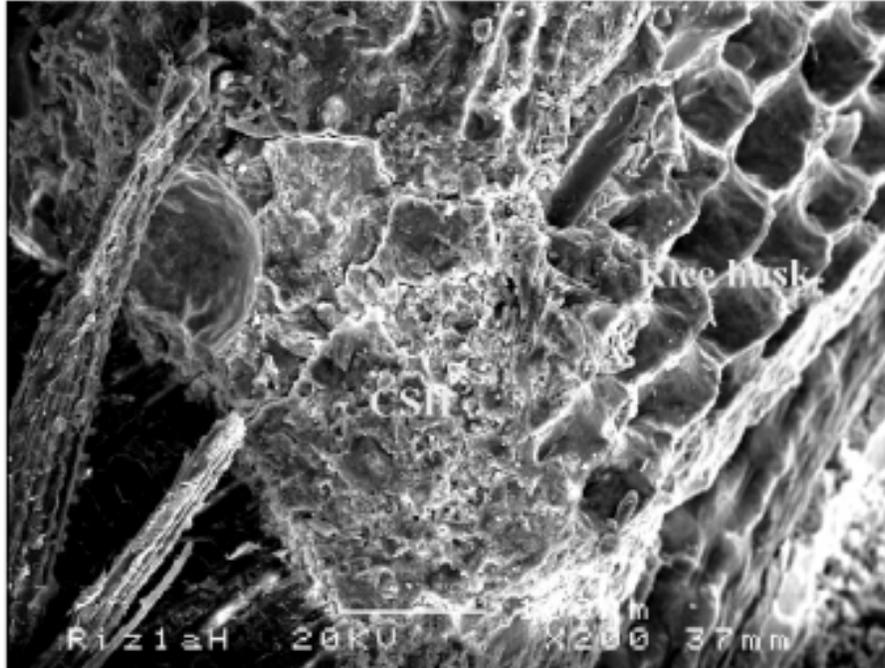
Figura 2.3. Micrografia de argamassa com casca de arroz. 200 X.
