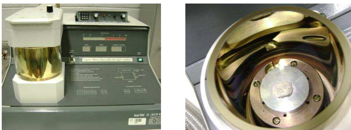
*Figura 3.20. (a) Sputtering (b) câmara com porta-amostras.*
