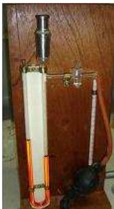
Figura 3.11. Aparelho permeabilímetro de Blaine.
