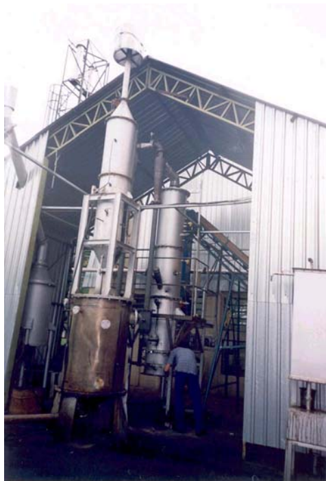
FIGURA 2.23 PLANTA PILOTO DA UNICAMP PARA A PIROLÍSE RÁPIDA DE BIOMASSA EM REATOR DE LEITO FLUIDIZADO
