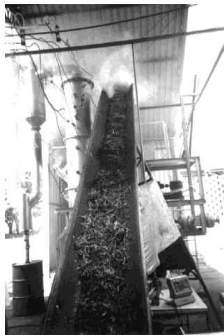
FIGURA 4.2 VAZAMENTO DE GASES PELO SISTEMA DE ALIMENTAÇÃO
