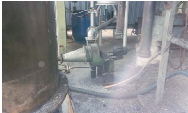
FIGURA 4.19 VENTILADOR CENTRIFUGO USADO PARA A SEPARAÇÃO DE AMOSTRAS DE BIO-ÓLEO
