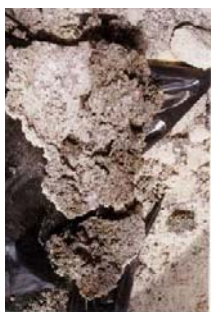
FIGURA 4.14 SINTERIZAÇÃO DO MATERIAL INERTE. A) PEDRAS NO LEITO; B) PAREDES DO REATOR
