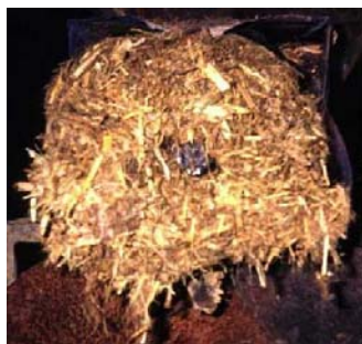
FIGURA 4.13 ASPECTO DA ROSCA DEPOIS DE COMPACTADA A BIOMASSA
