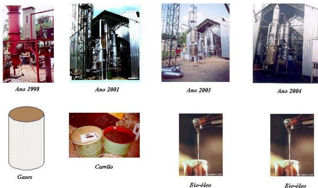
FIGURA 4.1 TRANSFORMAÇÕES MAIS IMPORTANTES DA PLANTA DE PIRÓLISE RÁPIDA DA UNICAMP. PRODUTOS OBTIDOS EM CADA ETAPA
