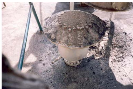
FIGURA 4.15 PEDRAS ACUMULADAS NO LEITO DE INERTE
