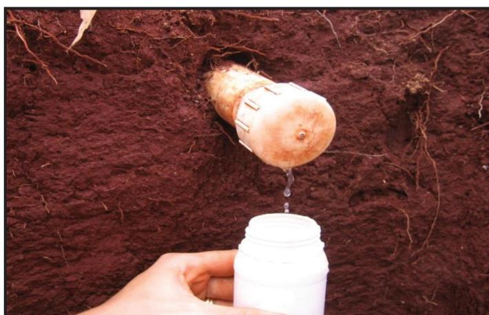
FIGURA 5.10. Coleta de amostra de solução do solo.
