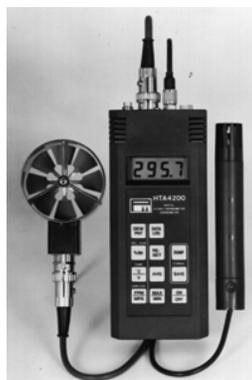
Figura 12. Termohigroanemômetro HTA Modelo 4200 PACER<sup>®</sup>.
