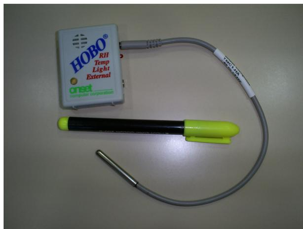
Figura 8 – Mini *datalogger* para coleta de dados ambientais internos ao galpão.
