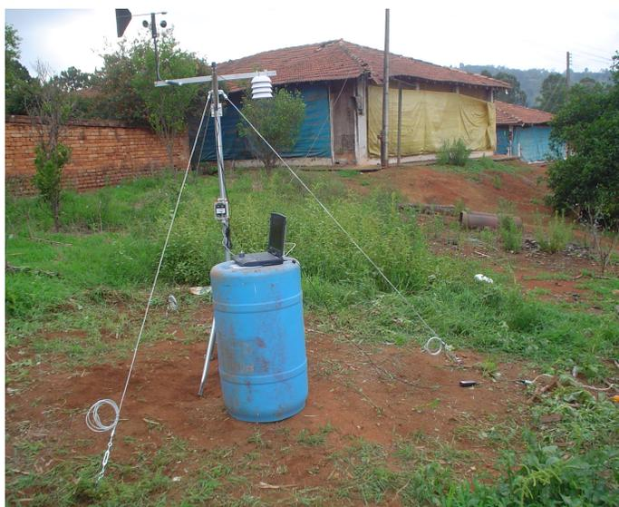
Figura 6 – Estação meteorológica sendo calibrada para início de coleta de dados.
