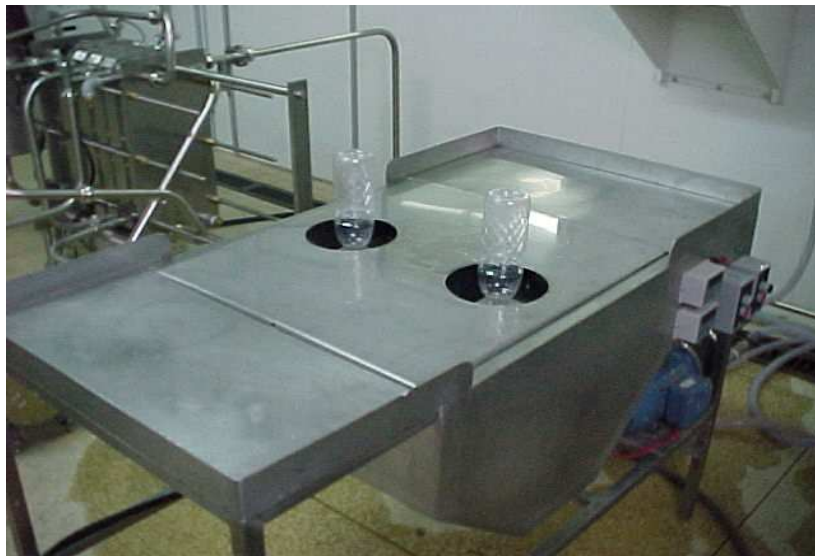
Equipamento utilizado na esterilização das garrafas
