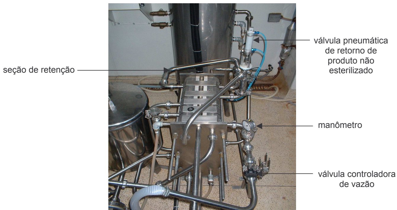
Trocador de calor a placas para tratamento UHT
