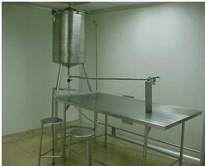
Linha de envase asséptico montada na sala limpa ISO classe 7
