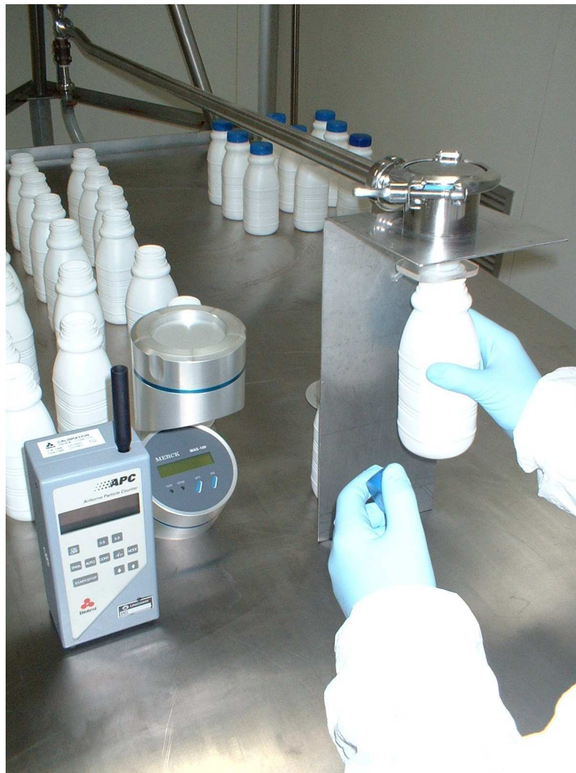
Detalhes do envase asséptico de leite em garrafas de PEAD com monitoração simultânea de partículas
