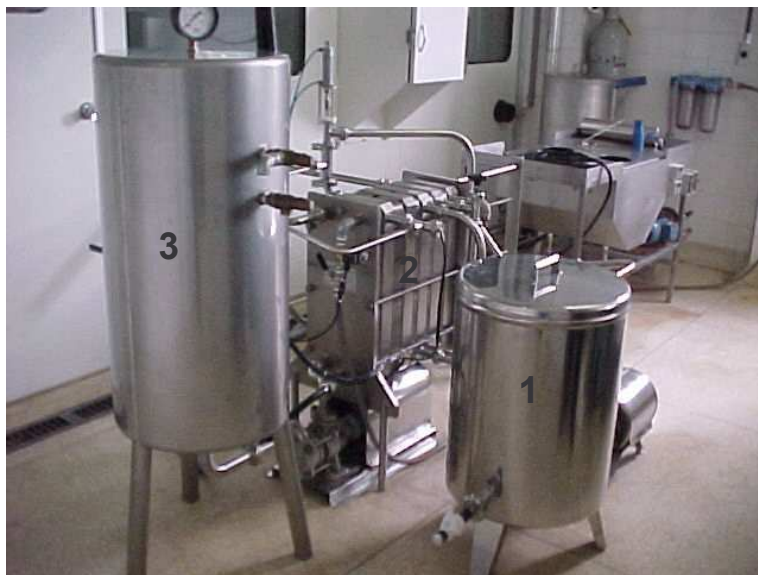
Conjunto de equipamentos utilizados no processamento do leite, constituído por tanque de equilíbrio (1), trocador de calor a placas (2) e tanque de água pressurizada (3)
