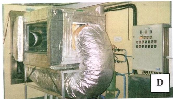
**FIGURA I. 1- Construção da câmara de congelamento horizontal e adaptação à unidade pré-existente. (A) Adaptação para o desvio da corrente de ar; (B) Montagem da câmara horizontal e isolamento térmico do sistema; (C) Revestimento externo e (D) Tubulação de retorno do ar ao evaporador.**
