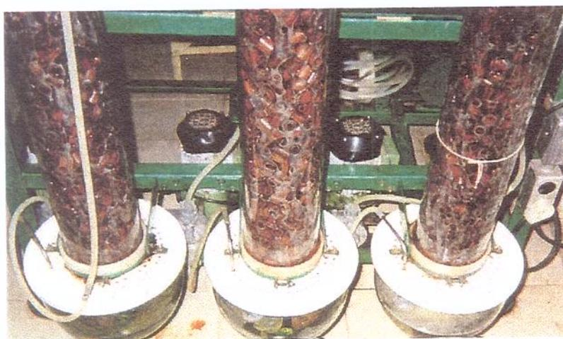
**Figura 07:** Colunas com material de preenchimento
